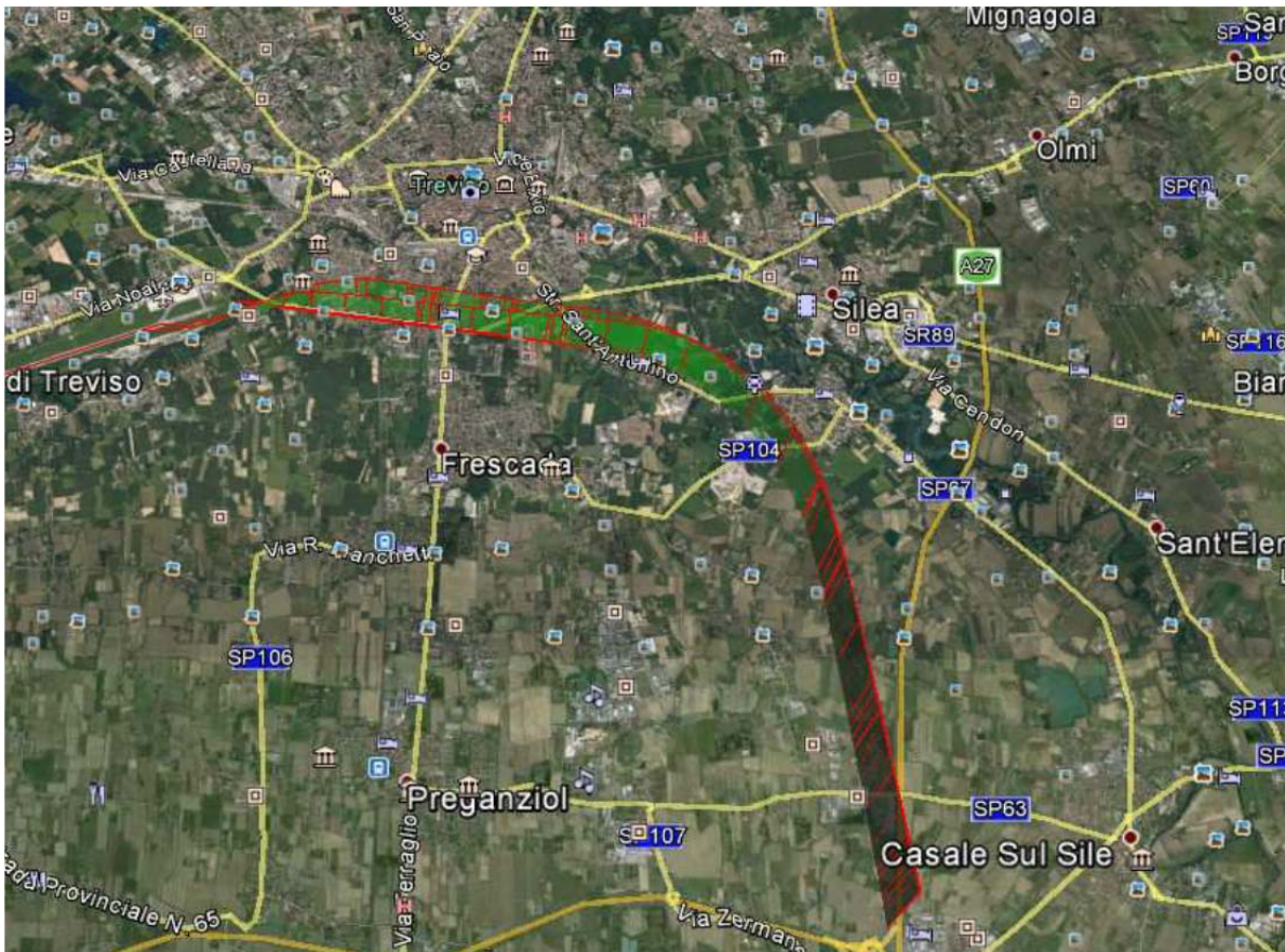
Figura B3-33 Traiettorie analizzate da ENAV nello “Studio progettuale relativo a procedure di salita iniziale per le piste 07 e 25 dell’Aeroporto di Treviso” per decolli da testata 07.
