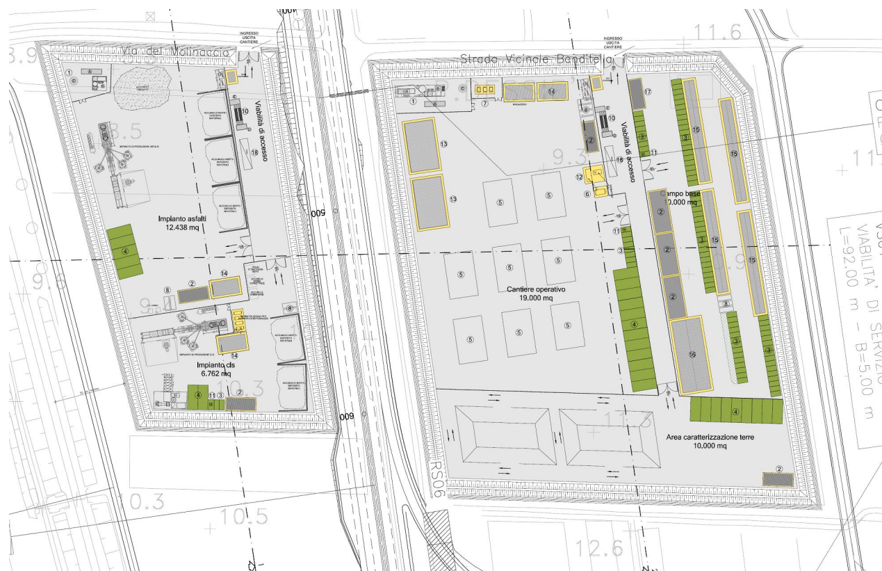
Layout aree di cantiere CB01
