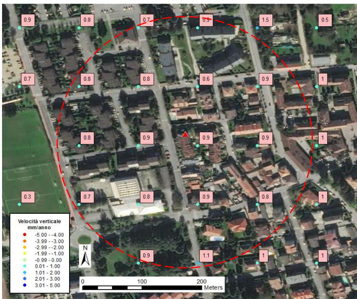
Fig. 16 – Visualizzazione del punto di riferimento utilizzato per la scomposizione Local (triangolo rosso) ed indicazione dei punti Regional più vicini con i rispettivi valori di velocità calibrati ed arrotondati ad una cifra decimale. L'area per la quale è stata calcolata la media delle velocità verticali è delimitata da un cerchio avente un raggio di circa 200 metri.
