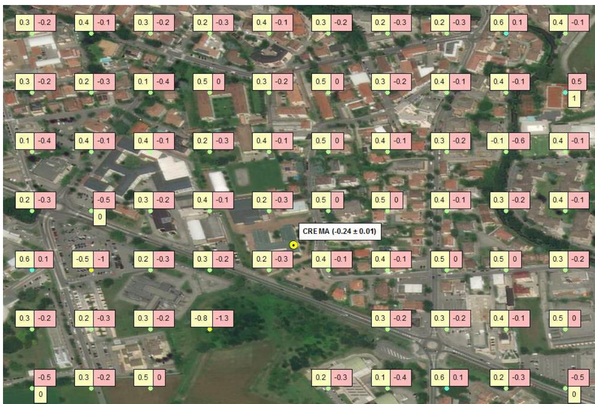
Fig. 9 – Dati Regional scomposti: in giallo i valori originali ed in rosa quelli corretti di -0.52 mm/anno, entrambi con arrotondamento ad una cifra decimale.
