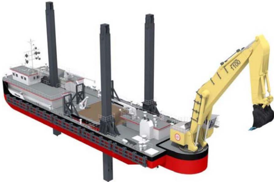
Figura 2.2 Tipologico di Draga con Escavatore
