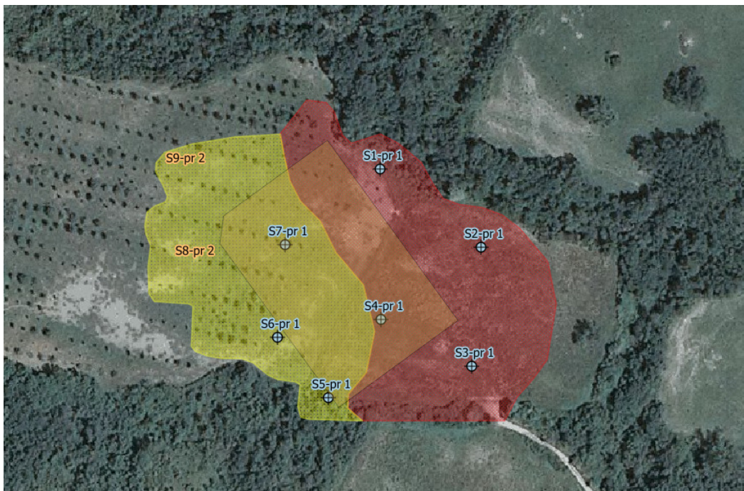
Figura 8-2 – Attività di scavo e riporto nel polo di reiniezione (in rosso gli scavi di profondità > 2 m, in arancio = 2 m, in celeste =1 m)
