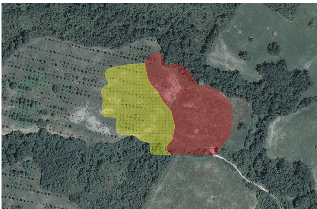
Figura 5-6 – Attività di scavo e riporto nel polo di produzione LUCIGNANO 2 (in giallo gli scavi, in rosso i riporti)
