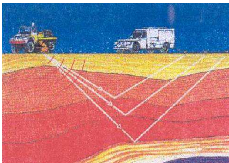
Figura 3-2: rilievo a vibratori
