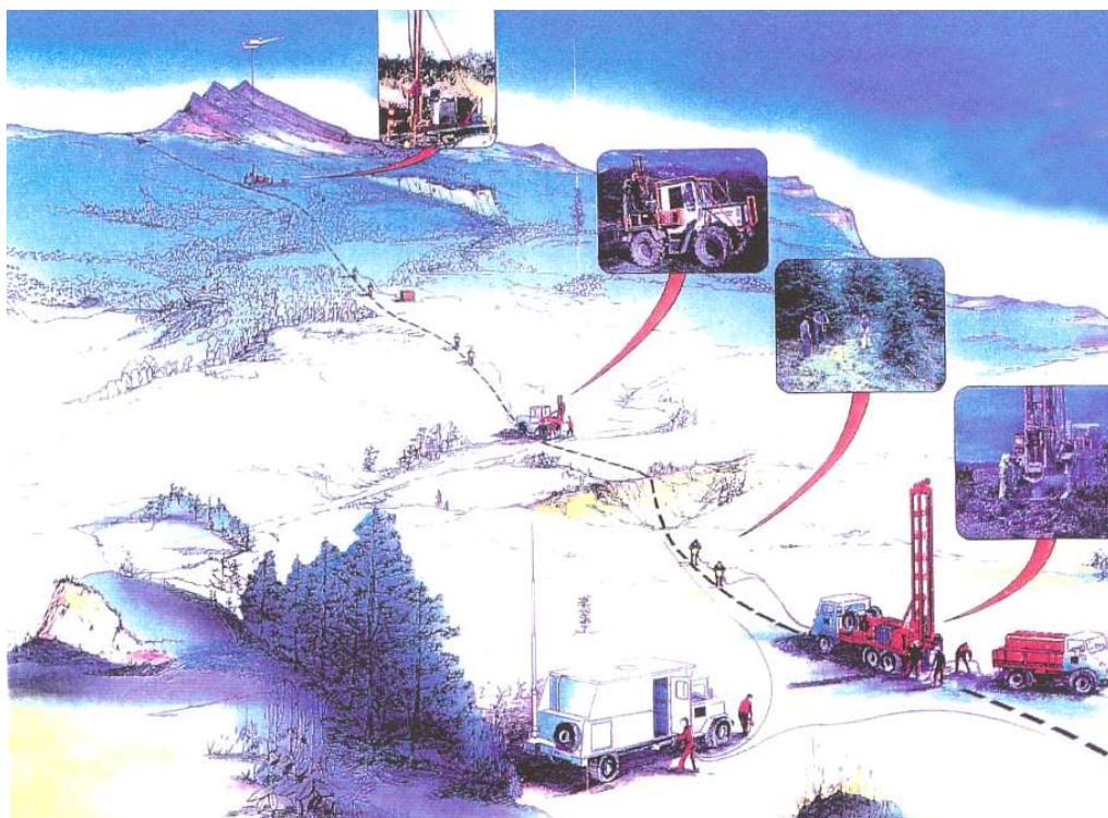
Figura 3-9: rappresentazione-tipo delle operazioni di campagna di un rilievo sismico 2D
