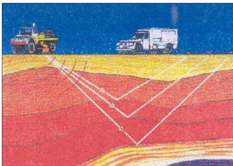
Figura 3-2: rilievo a vibratori
