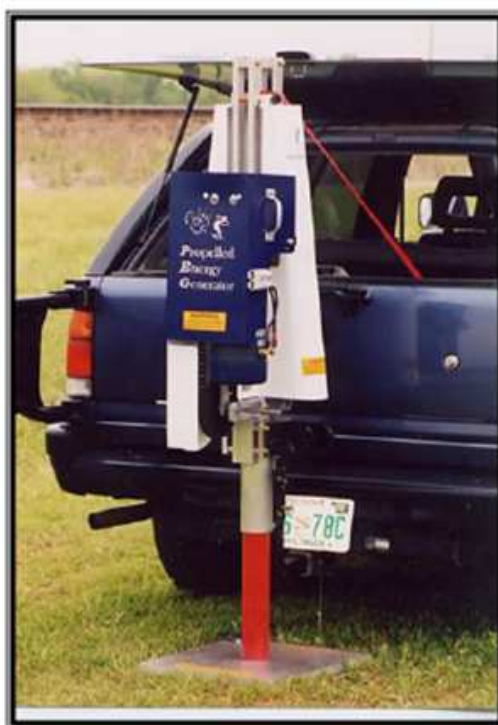
Figura 3-8: esempio di sistema “Weight Drop”
