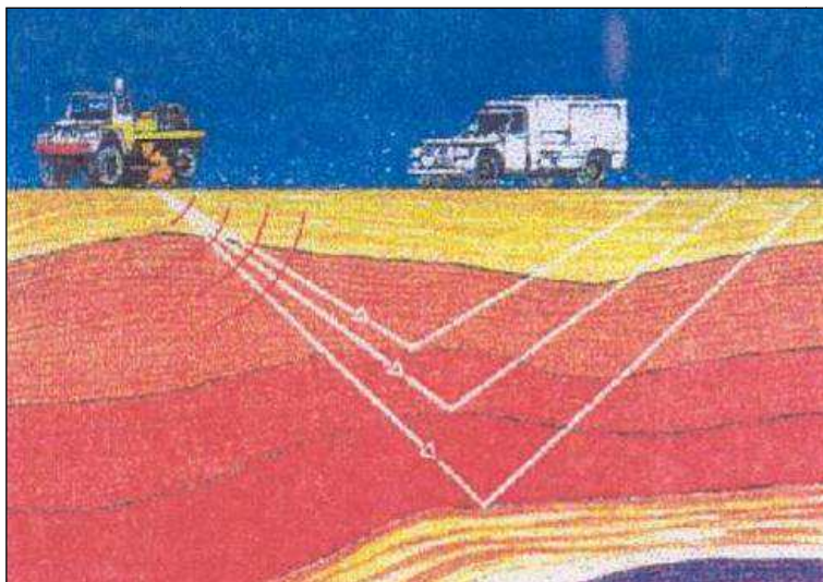
Figura 3-2: rilievo a vibratori
