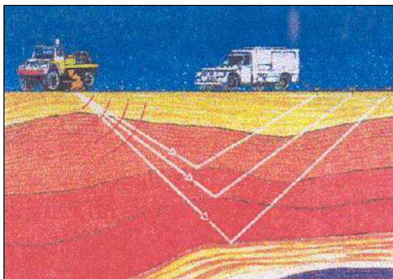
Figura 4-4: Rilievo a vibratori
