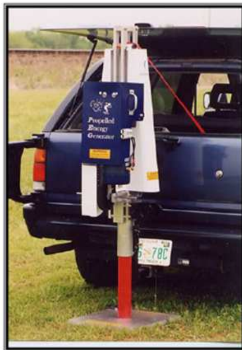
Figura 4-6: esempio di sistema "Weight Drop"
