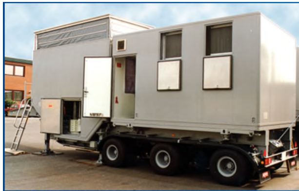
Figura 3-5 – Trailer con super-compattatore mobile
