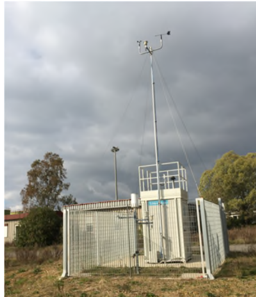
Figura 4-7 – Foto della centralina di qualità dell'aria installata presso la Centrale nucleare di Latina
