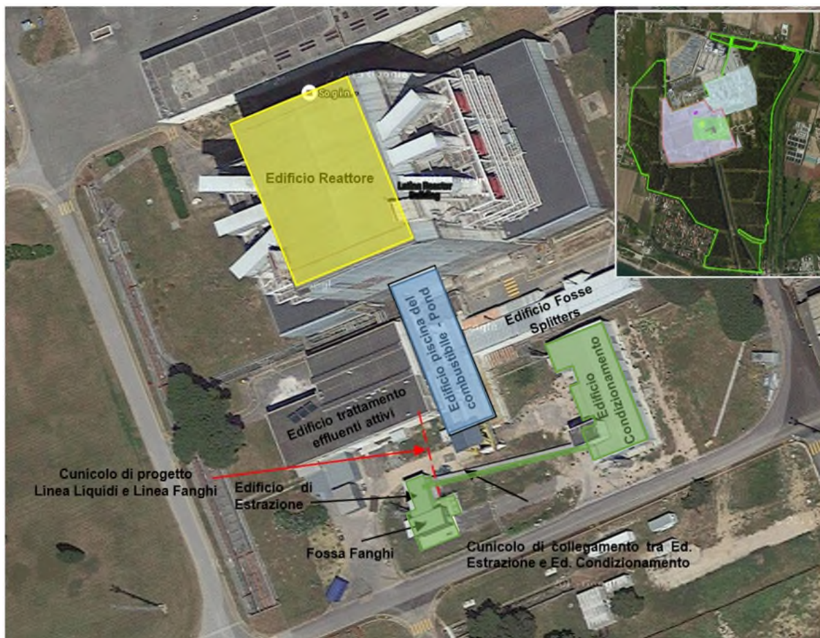
Figura 3-3 – Localizzazione dell'Impianto LECO e delle strutture e dei manufatti esistenti
