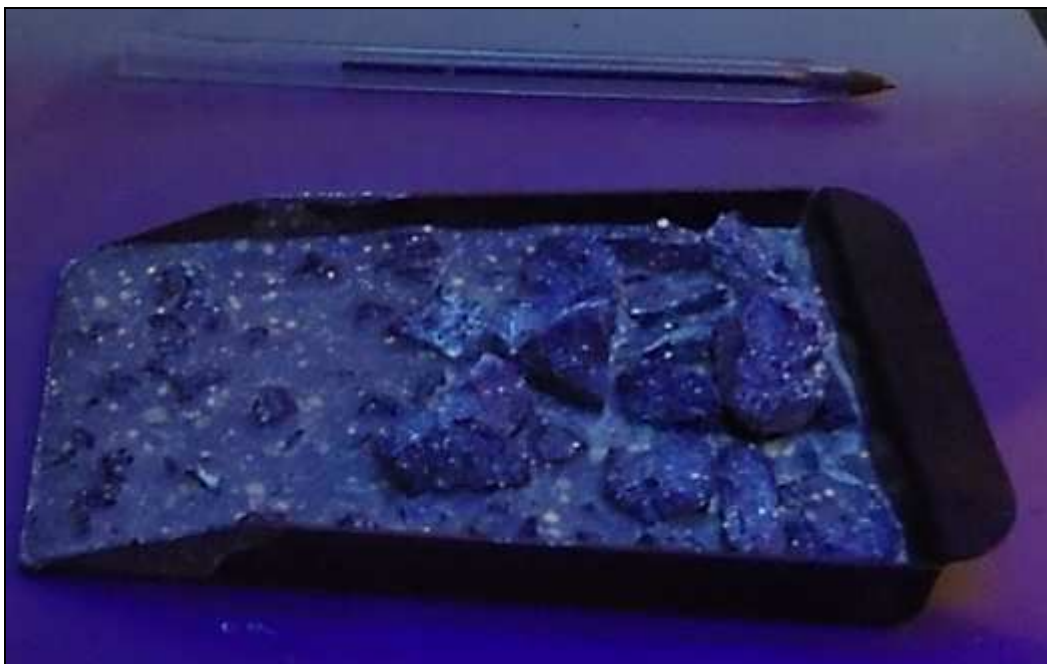
Figura 4-10: Fluorescenza su campione di fango a fine carotaggio
