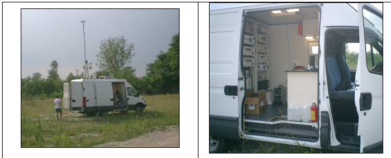
Figura 2-2: monitoraggio qualità dell'aria mediante mezzo mobile
