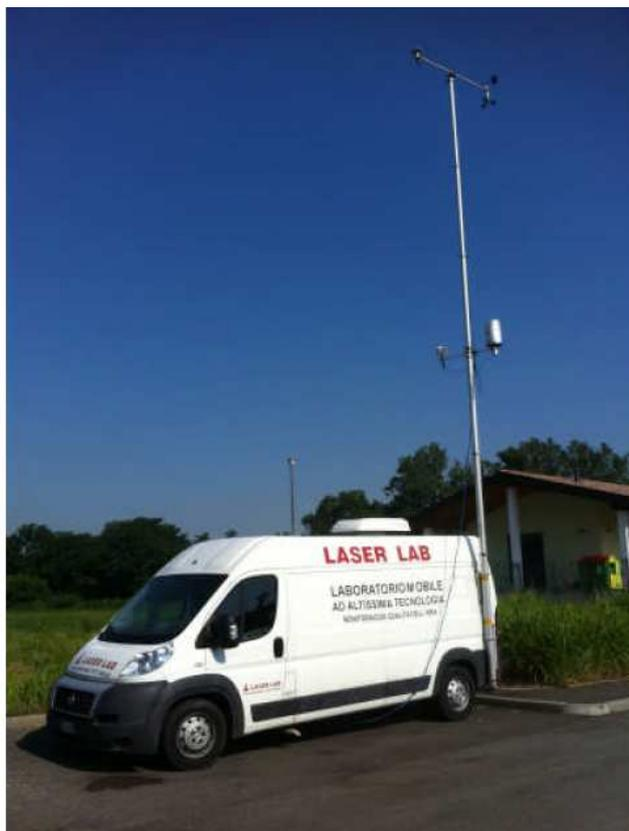
**Figura 5-8: monitoraggio qualità dell'aria mediante mezzo mobile**
