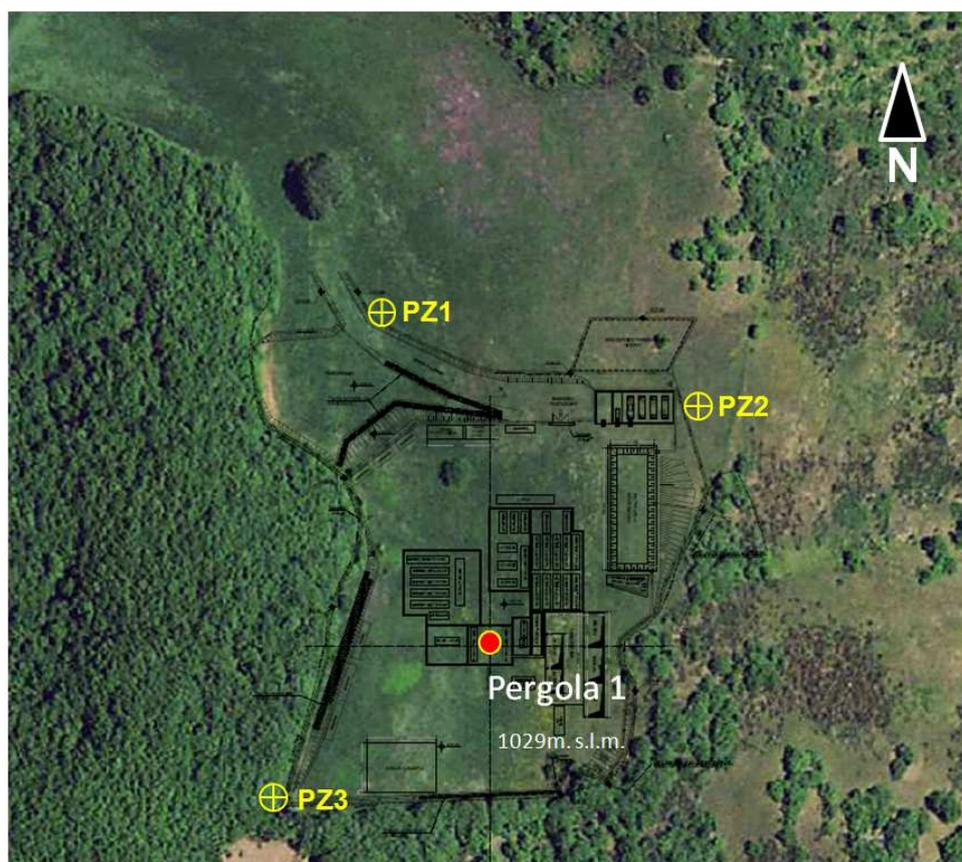
**Figura 3-1: Ubicazione dei piezometri realizzati presso la futura area pozzo Pergola 1**
