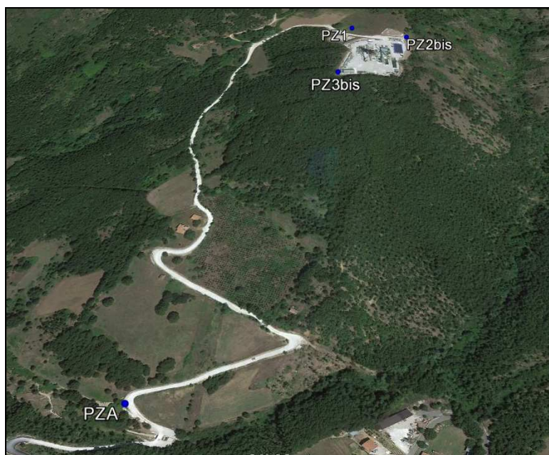
Figura 4: Foto aerea con ubicazione dei piezometri realizzati per il monitoraggio delle acque sotterranee
