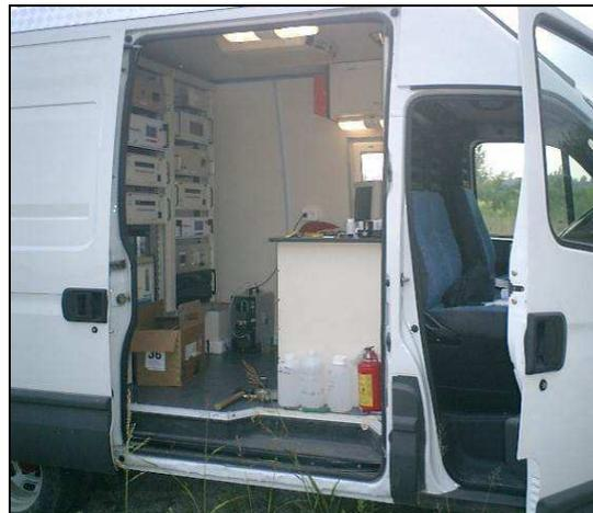
**Figura 2-5: Monitoraggio della qualità dell'aria mediante stazione mobile**
