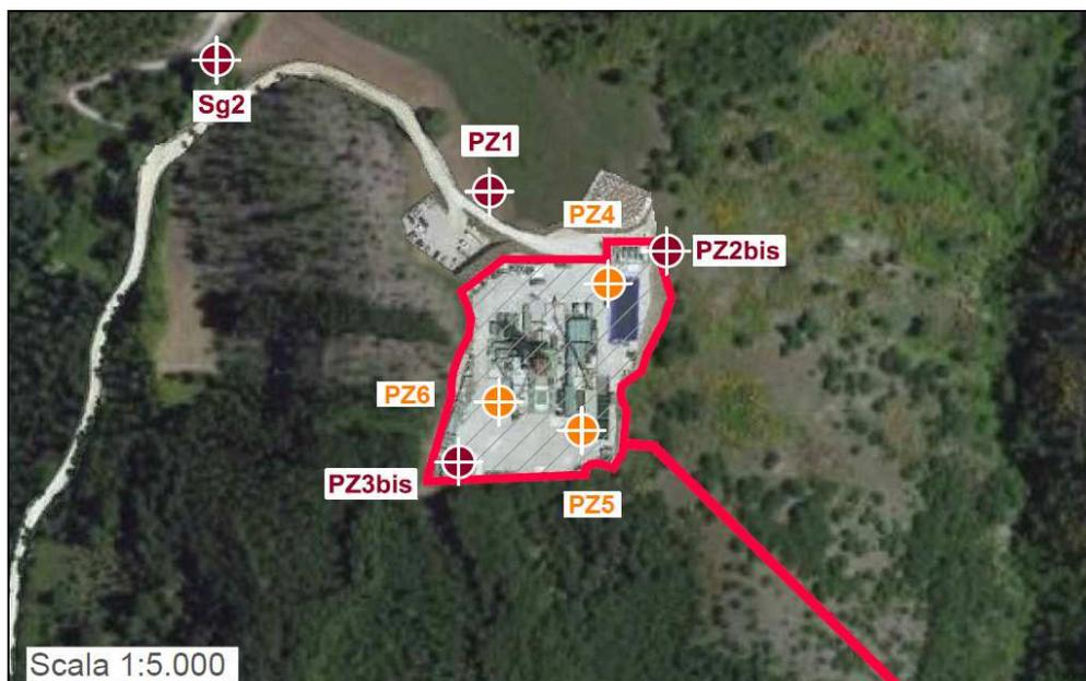
**Figura 5-3: Particolare dei punti di ubicazione dei monitoraggi delle acque sotterranee e delle sorgenti presso l'Area Pozzo Pergola 1 nella fase *Ante Operam*. I punti PZ4, PZ5 e PZ6 corrispondono ai piezometri che saranno installati solo qualora si riscontasse la presenza della falda a seguito dei sondaggi *Ante Operam* previsti per il suolo**
