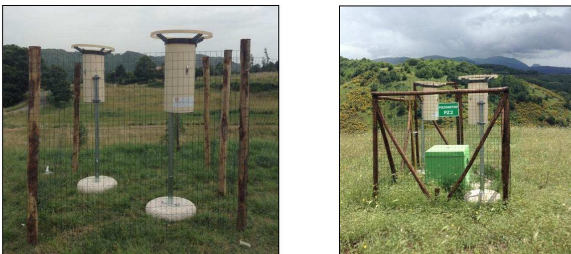
**Figura 2-8: Esempi di posizionamento di deposimetri**
