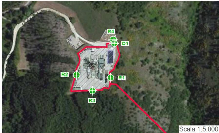
Figura 2-3: Particolare dei punti di monitoraggio della qualità dell'aria presso l'Area Pozzo Pergola
