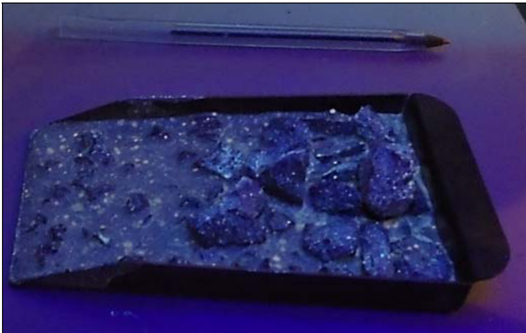
Figura 16: Fluorescenza su campione di fango a fine carotaggio
