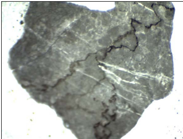
Figura 11: Microfratture con olio a 3268 m
