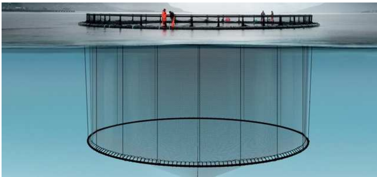
Illustrazione della parte emersa e sommersa di una gabbia. La gabbia emerge per circa 1,5m dalla superficie.
