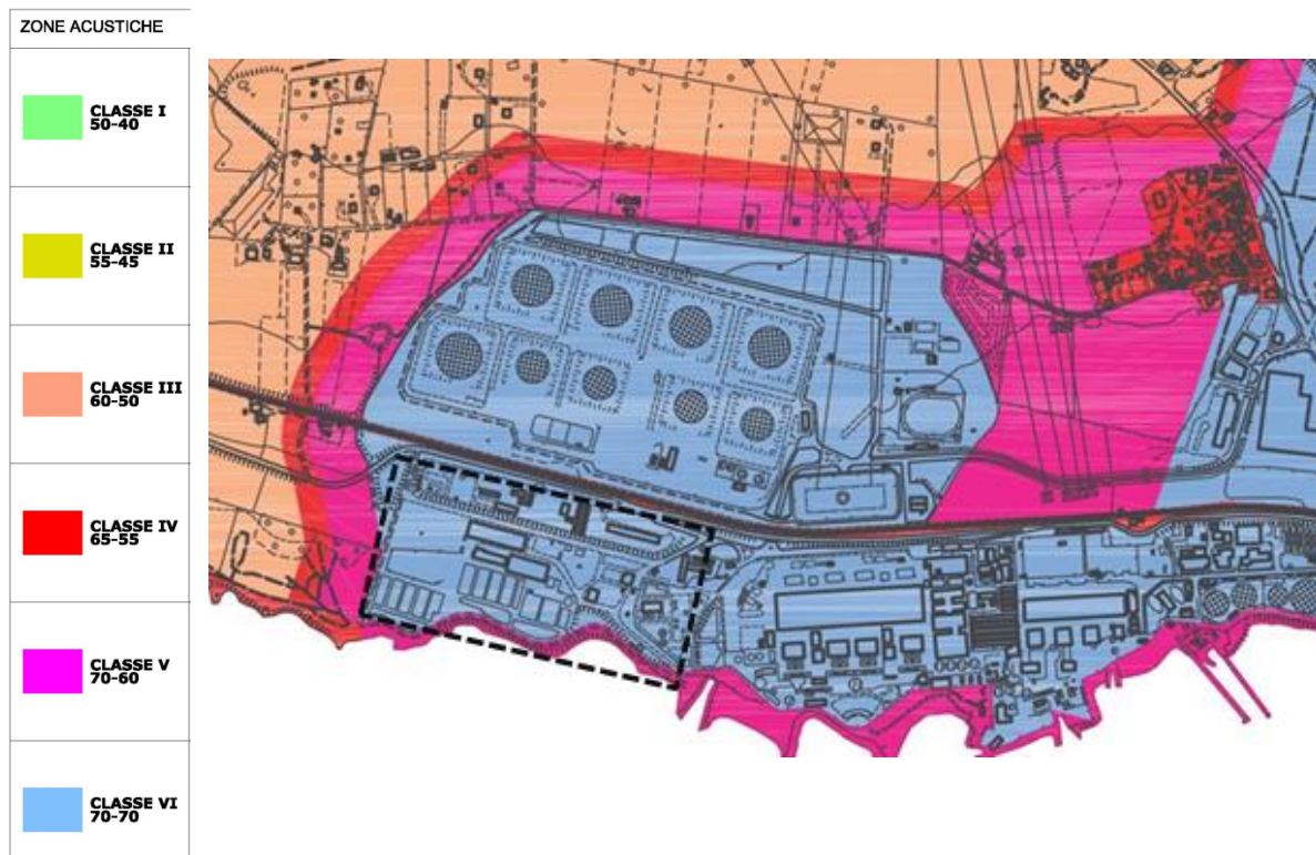
Figura 4.6.1 – Torrevaldaliga: stralcio della classificazione acustica comunale per l'area circostante l'impianto esistente a terra
