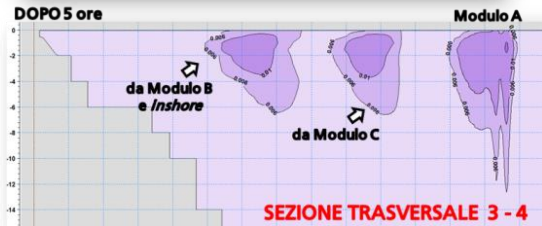
Figura 61 SCENARIO n. 3 misto . Mappe di concentrazione (mg/l) del componente P calcolate secondo due sezioni verticali (direzione Z) trasversali a riva, dopo 5 ore dall'inizio del rilascio di nutrienti dalle reti del futuro allevamento ittico offshore e dallo scarico P2 di quello esistente a riva.
