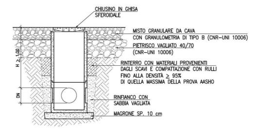
SEZIONE TIPO SU POZZETTO
