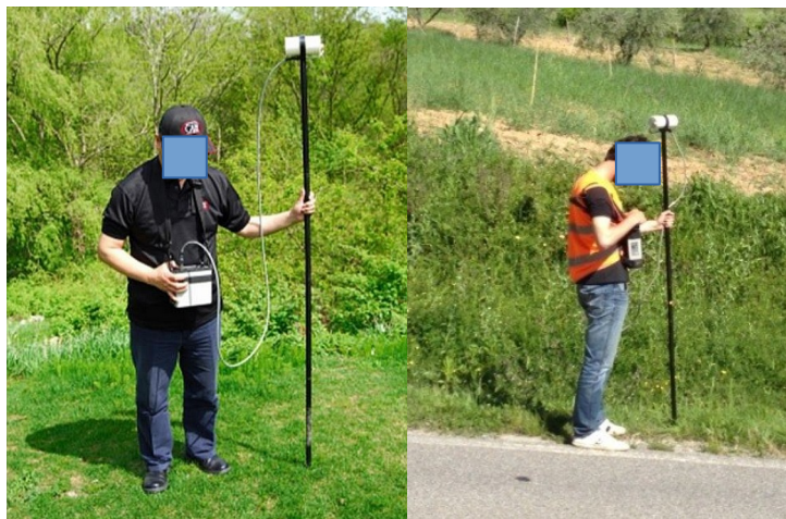
Fig. 6. Addetti al lavoro nell'acquisizione dati magnetometrici
