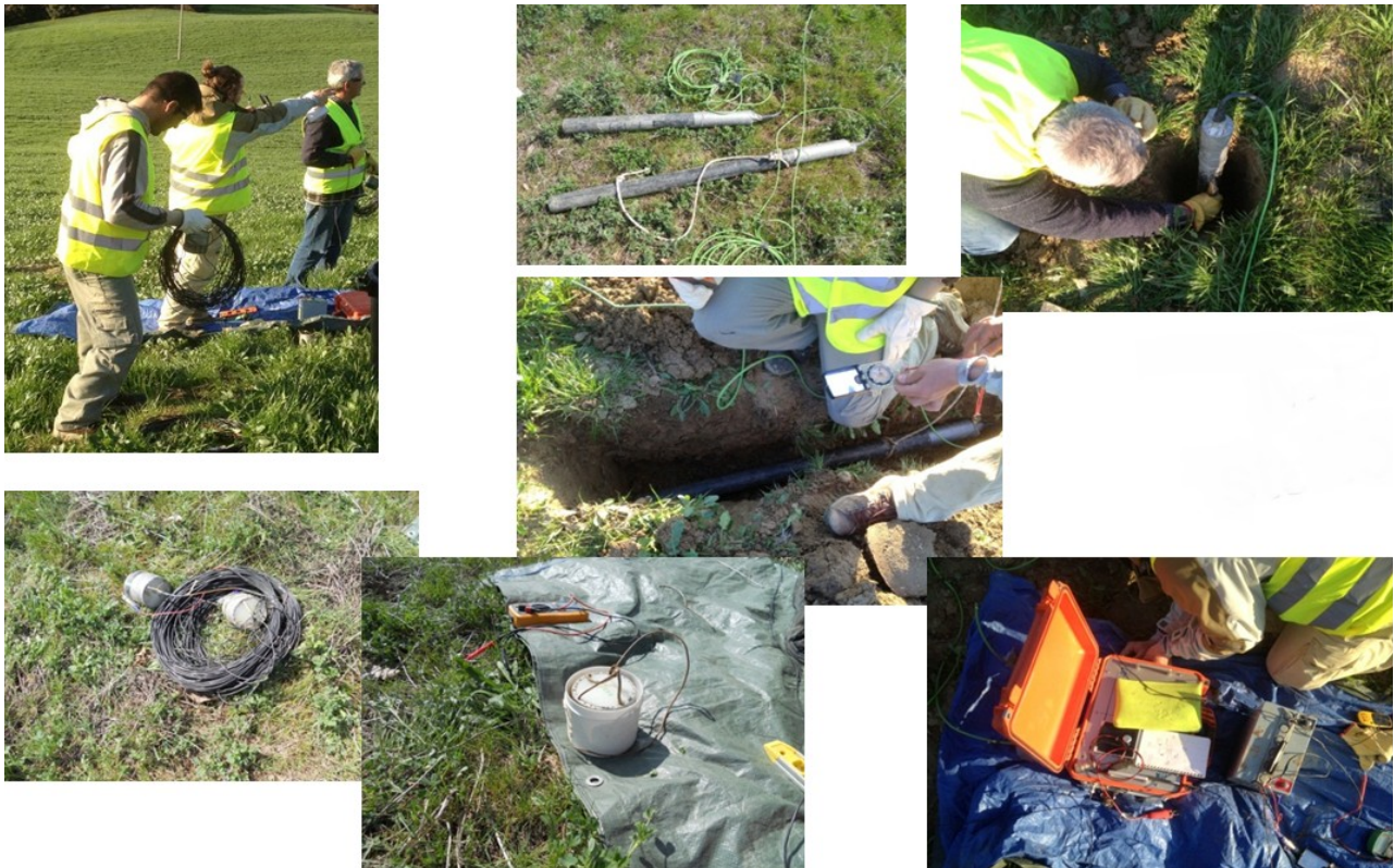
Fig. 9. Addetti al lavoro per la realizzazione di una stazione MT
