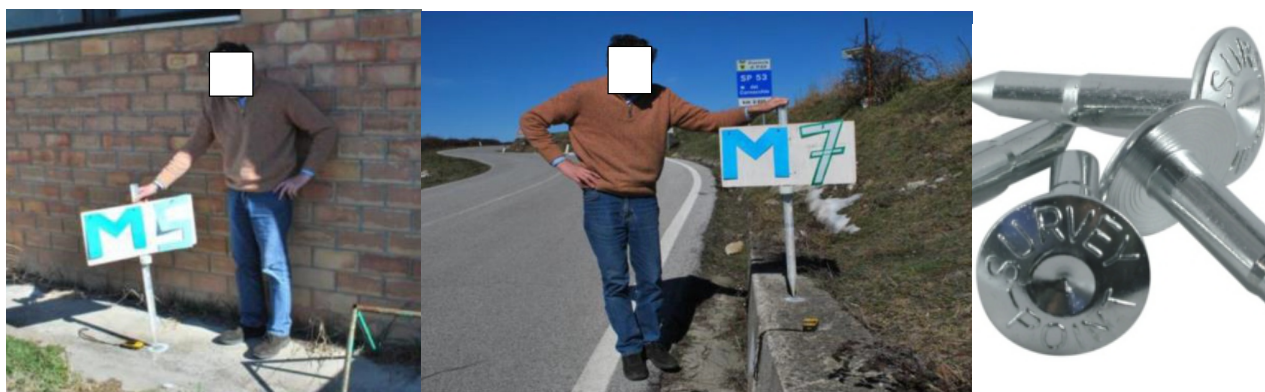
Fig. 4. Esempi di capisaldi del Base Network, materializzati da un chiodo topografico.
