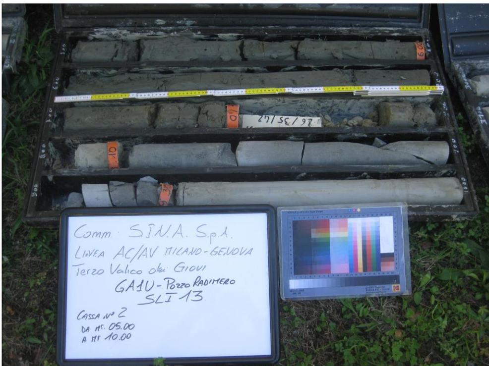
Figura 5-8 – Passaggio di versante depositi-substrato alterato – SLI13
