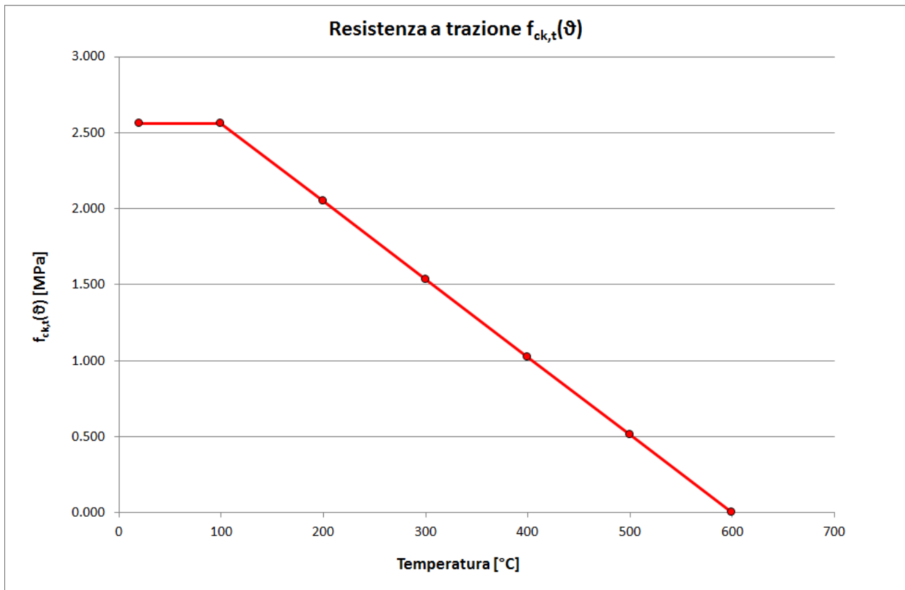
Figura 6 – Resistenza a trazione in funzione della temperatura ( R_{ck} = 30 MPa)
