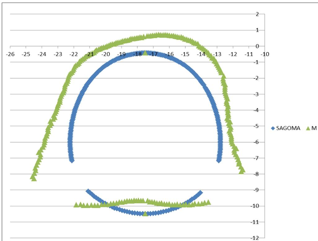
Figura 63 – Azione flettente – Curva EUREKA – t = 120 min (Scala 1m=500KNm)
