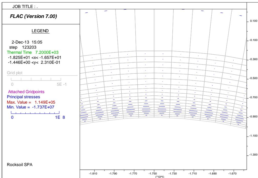
Figura 34 – Stato tensionale – Curva UNI11076 – t = 120 min
