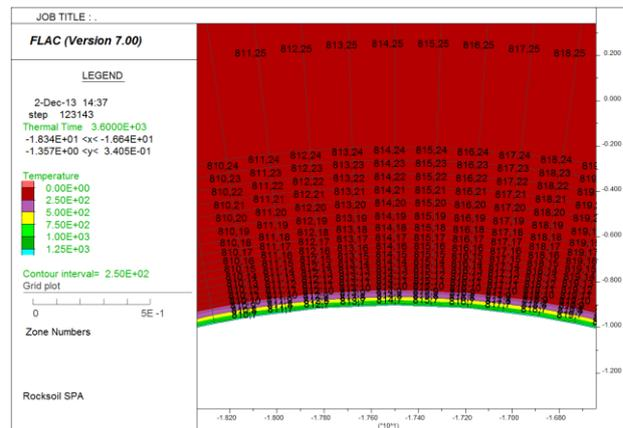
**Figura 17 – Distribuzione della temperatura del rivestimento – Curva UNI11076**
