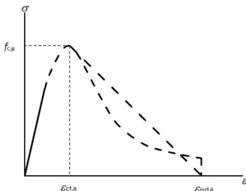
Figura 3 – Legame tensioni-deformazioni del calcestruzzo ad elevate temperature
