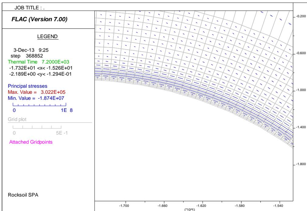
Figura 59 – Stato tensionale – Curva UNI11076 – t = 120 min
