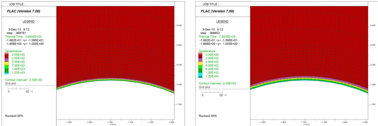
**Figura 42 – Distribuzione della temperatura del rivestimento – Curva UNI11076**
