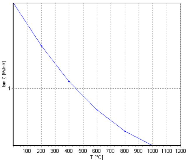
Figure 1: Conduttività termica del calcestruzzo (EN 1992-1-2 p.3.4 – fig.3.7)
