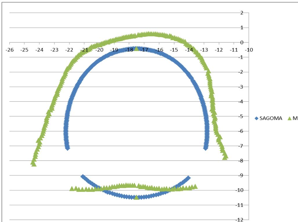
Figura 65 – Azione flettente – UNI11076– t = 120 min (Scala 1m=500KNm)
