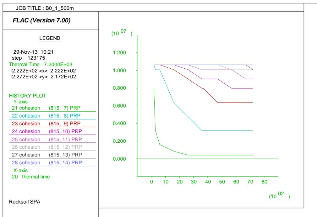
**Figura 26 – Evoluzione del valore di coesione c'nel rivestimento – Curva EUREKA**
