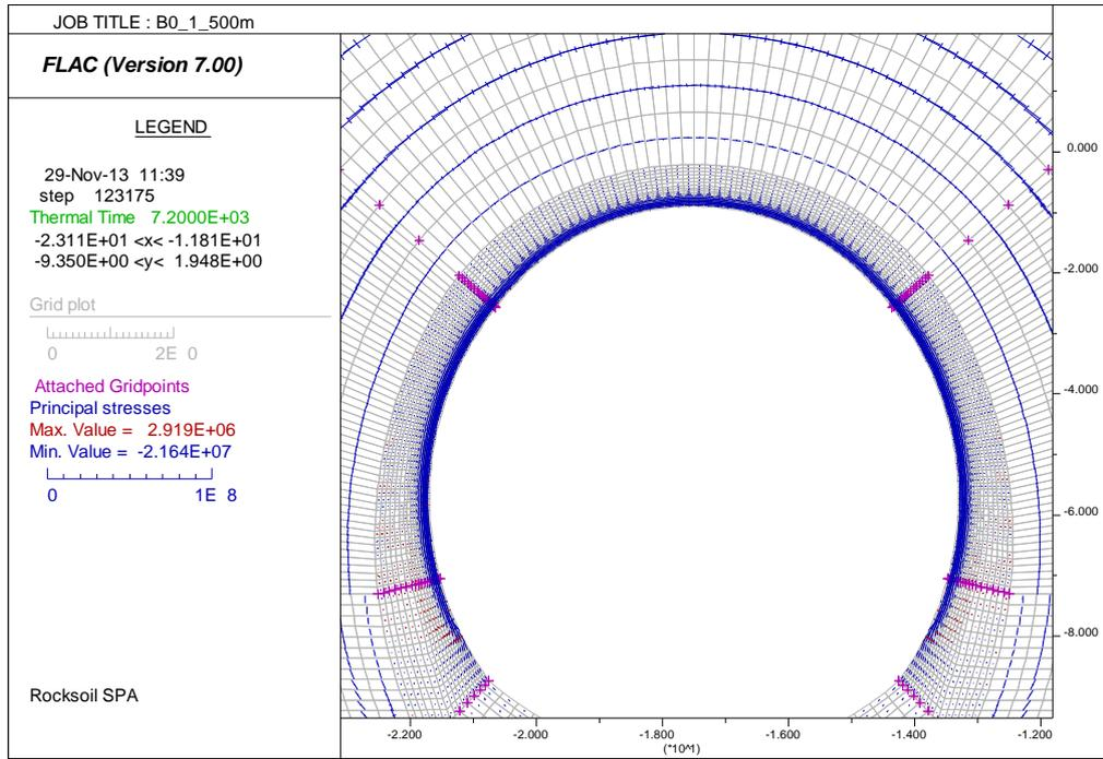
**Figura 30 – Stato tensionale – Curva EUREKA – t = 120 min**
