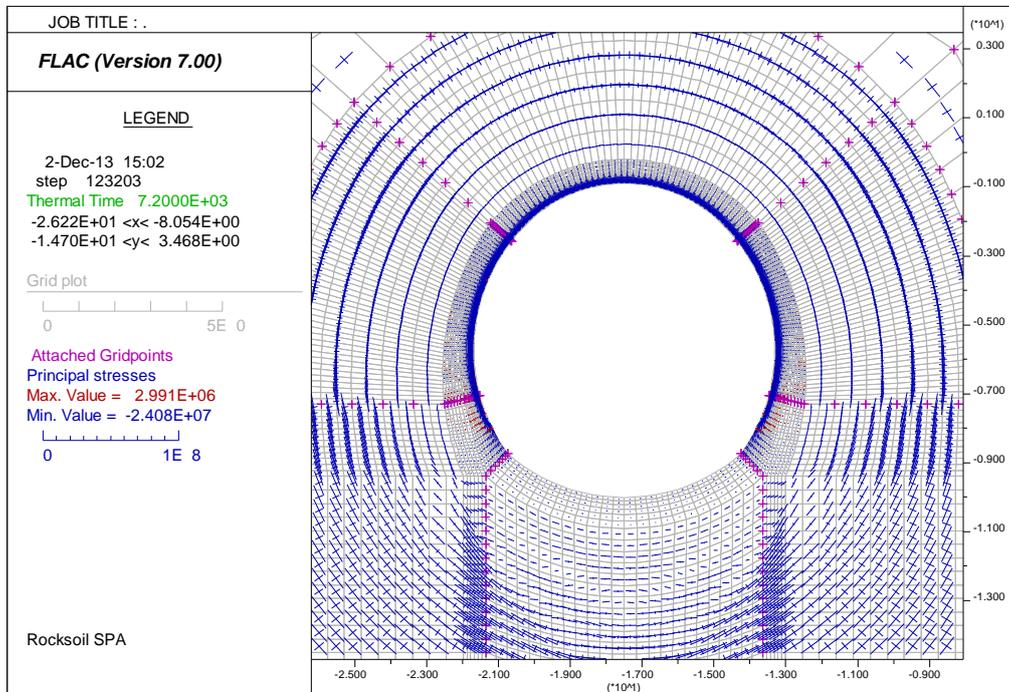
Figura 33 – Stato tensionale – Curva UNI11076 – t = 120 min
