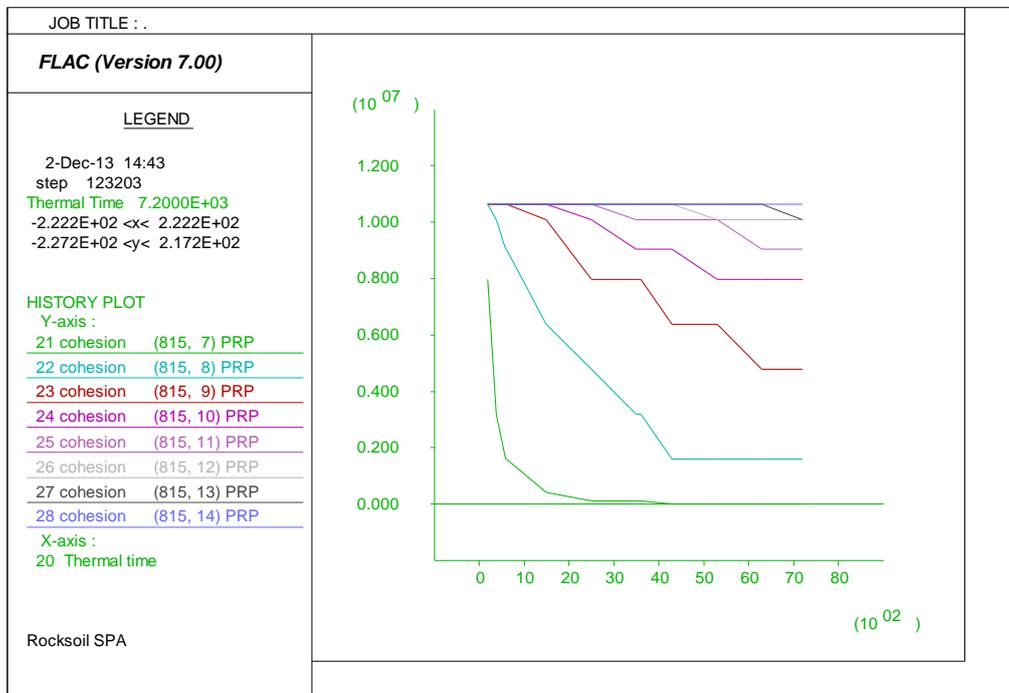
**Figura 28 – Evoluzione del valore di coesione c'nel rivestimento – Curva UNI11076**
