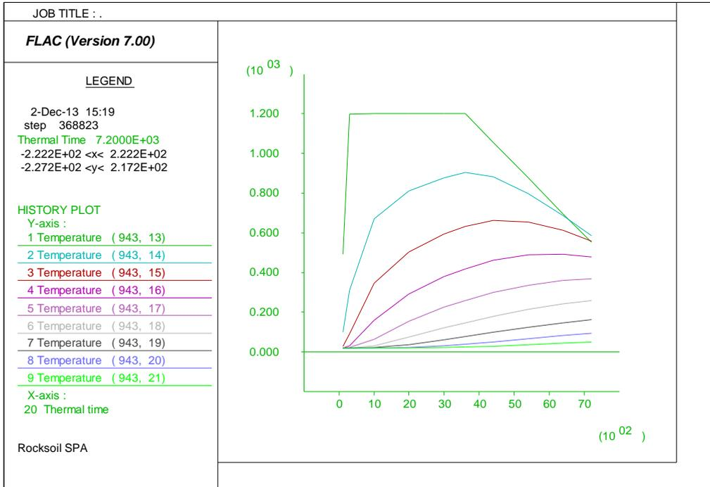
**Figura 44 – Evoluzione della temperatura nel rivestimento – Curva EUREKA**
