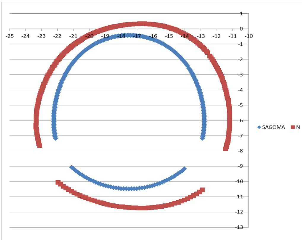
Figura 62 – Azione assiale – Curva EUREKA – t = 120 min (Scala 1m=5000KN)
