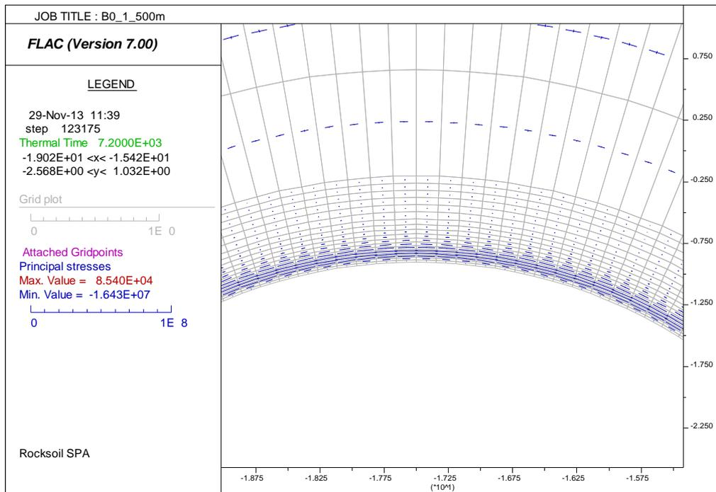
**Figura 31 – Stato tensionale – Curva EUREKA – t = 120 min**
