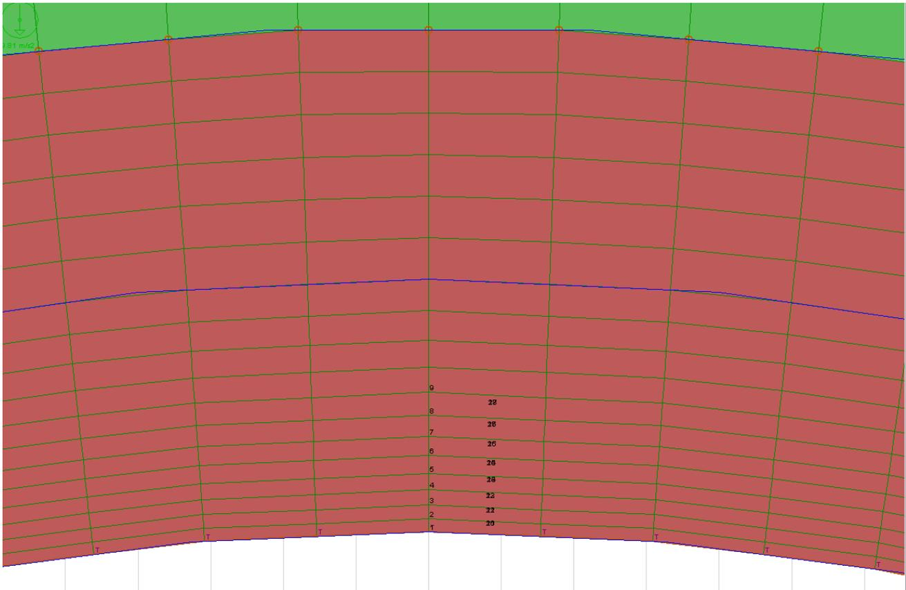
**Figura 18 – Punti di controllo per l'evoluzione della temperatura e delle proprietà meccaniche**
