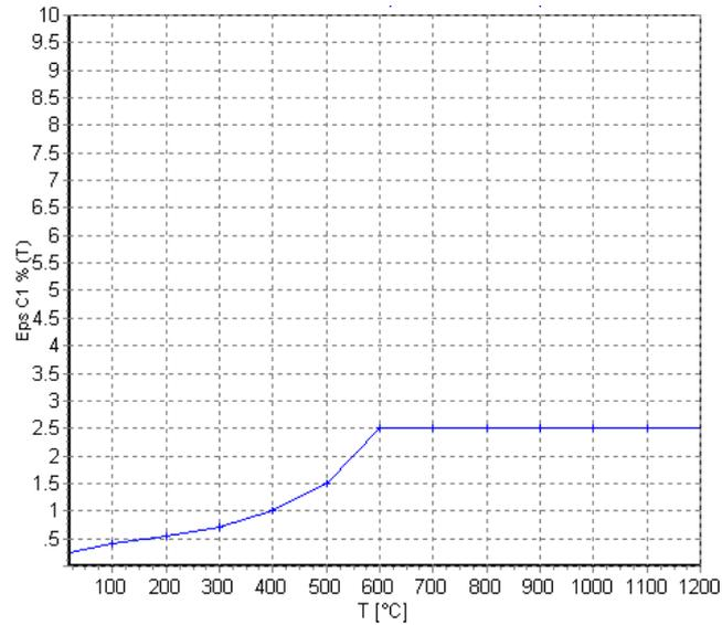
Figure 4: Fattore di riduzione del valore di  $\epsilon_{sc1}$  per il calcestruzzo (EN 1992-1-2 p.3.2.2.1 – tab.3.1)
