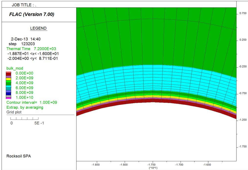
**Figura 23 – Evoluzione del bulk modulus nella sezione – Curva UNI11076 (120min)**
