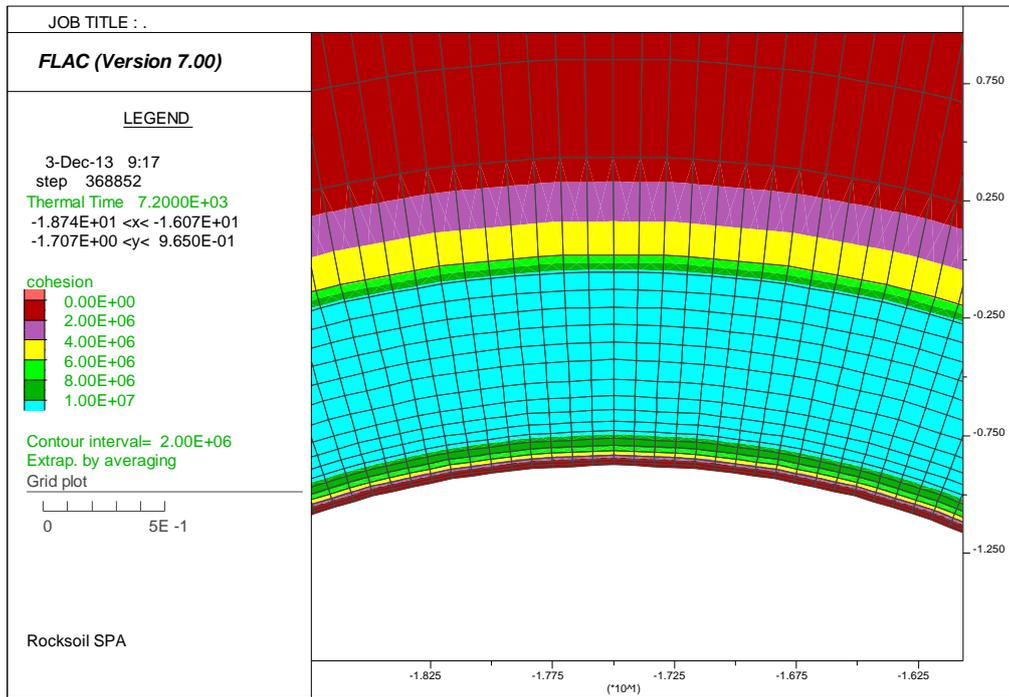
**Figura 49 – Evoluzione della coesione  $c'$  – Curva UNI11076 (120min)**
