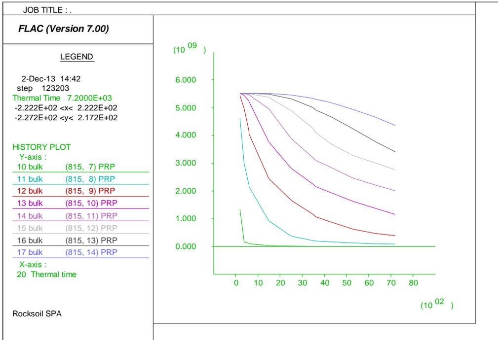
**Figura 27 – Evoluzione del bulk modulus nel rivestimento – Curva UNI11076**
