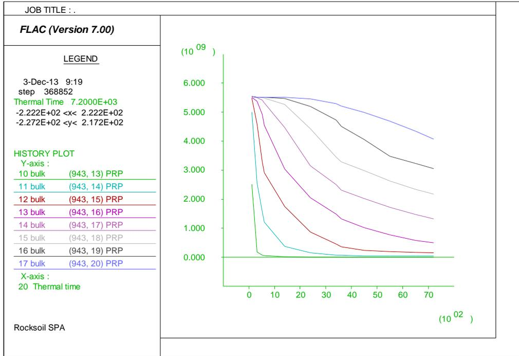
**Figura 52 – Evoluzione del bulk modulus nel rivestimento – Curva UNI11076**
