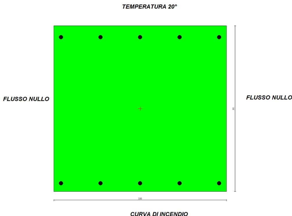
**Figure 8: Schematizzazione della sezione e condizioni al contorno**
