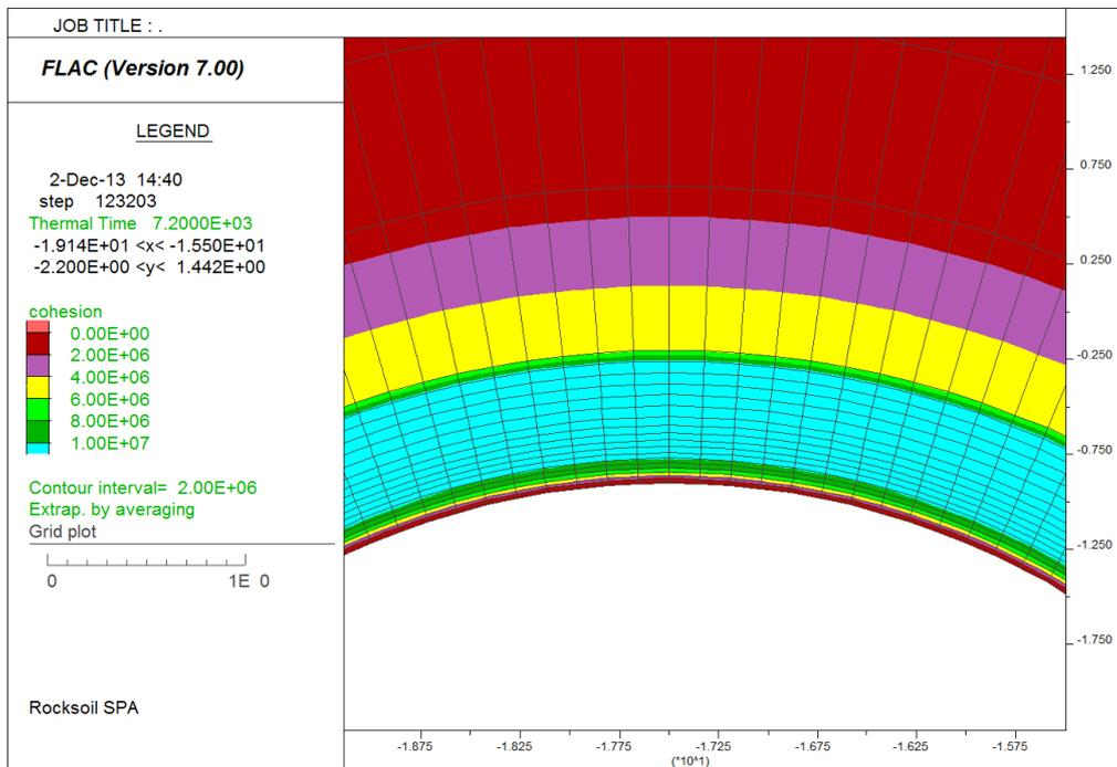
**Figura 24 – Evoluzione della coesione c' – Curva UNI11076 (120min)**
