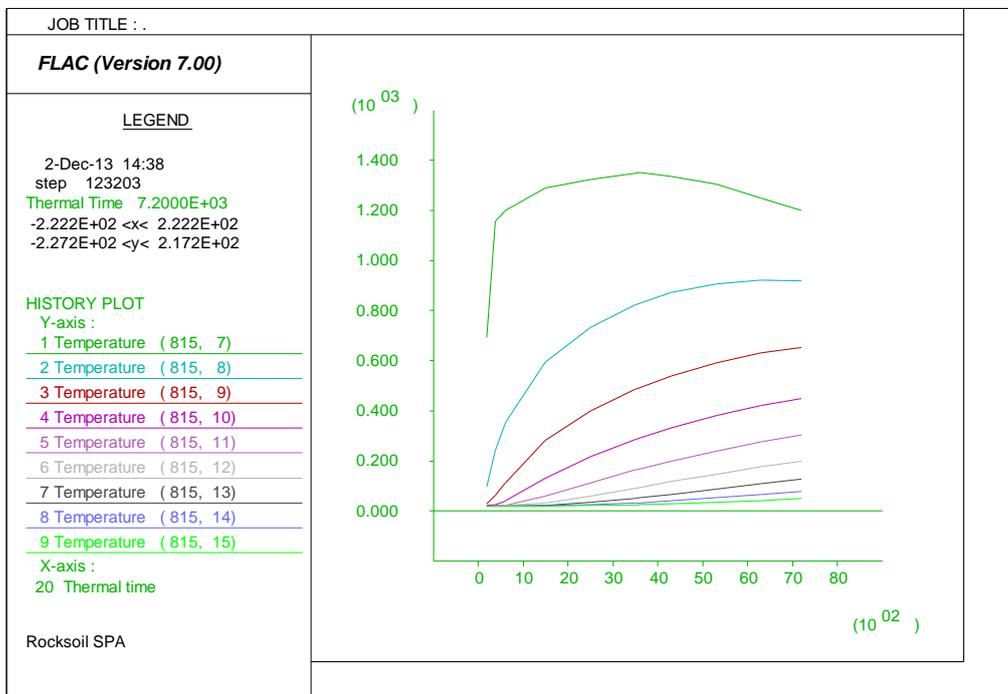
**Figura 20 – Evoluzione della temperatura nel rivestimento – Curva UNI11076**
