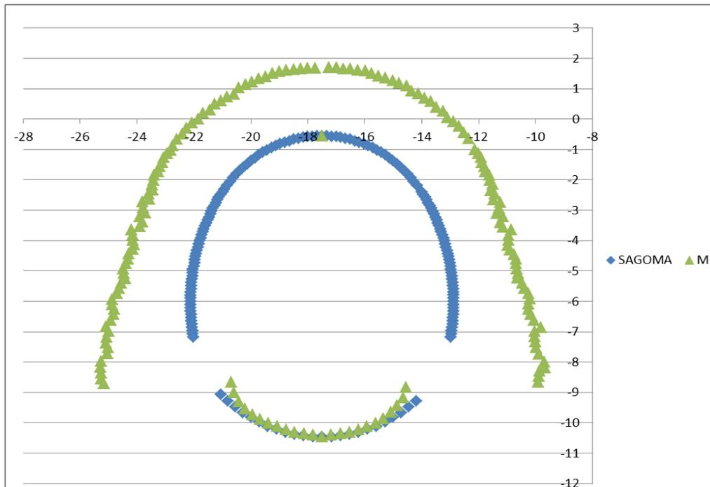
Figura 40 – Azione flettente – Curva UNI – t = 120 min (Scala 1m=200KNm)
