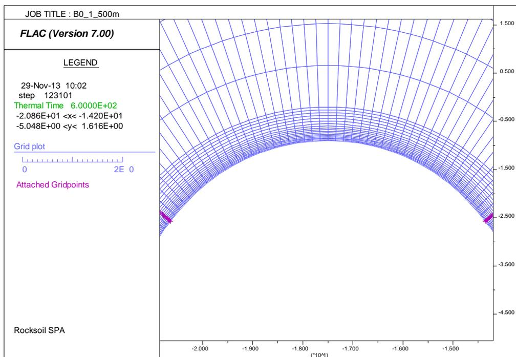
**Figura 15 – Mesh di calcolo – Aspect ratio intradosso conci**
