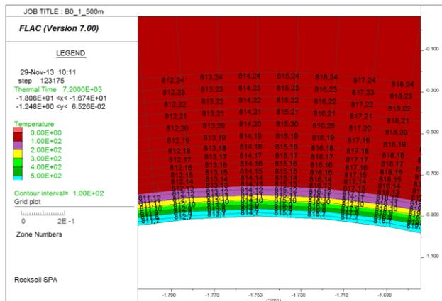
**Figura 16 – Distribuzione della temperatura del rivestimento – Curva EUREKA**
