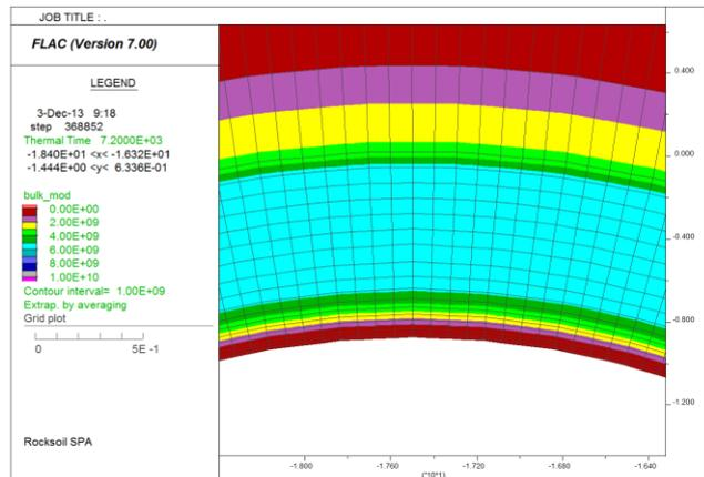
Figura 48 – Evoluzione del bulk modulus nella sezione – Curva UNI11076 (120min)
