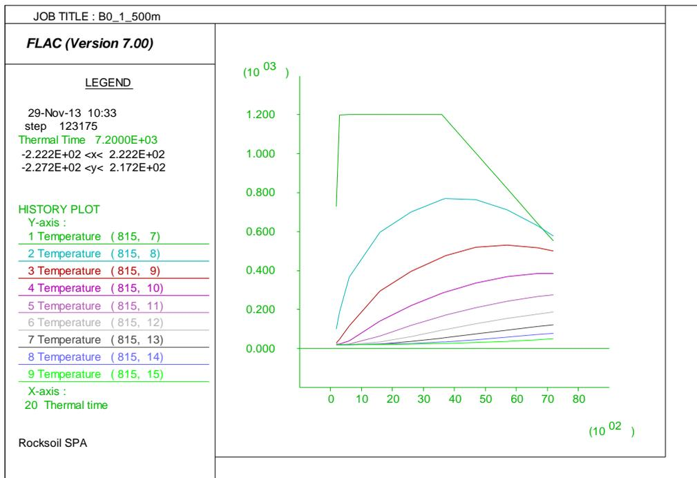
**Figura 19 – Evoluzione della temperatura nel rivestimento – Curva EUREKA**
