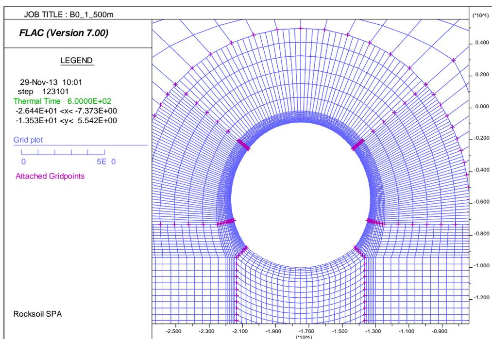
Figura 14 – Mesh di calcolo
