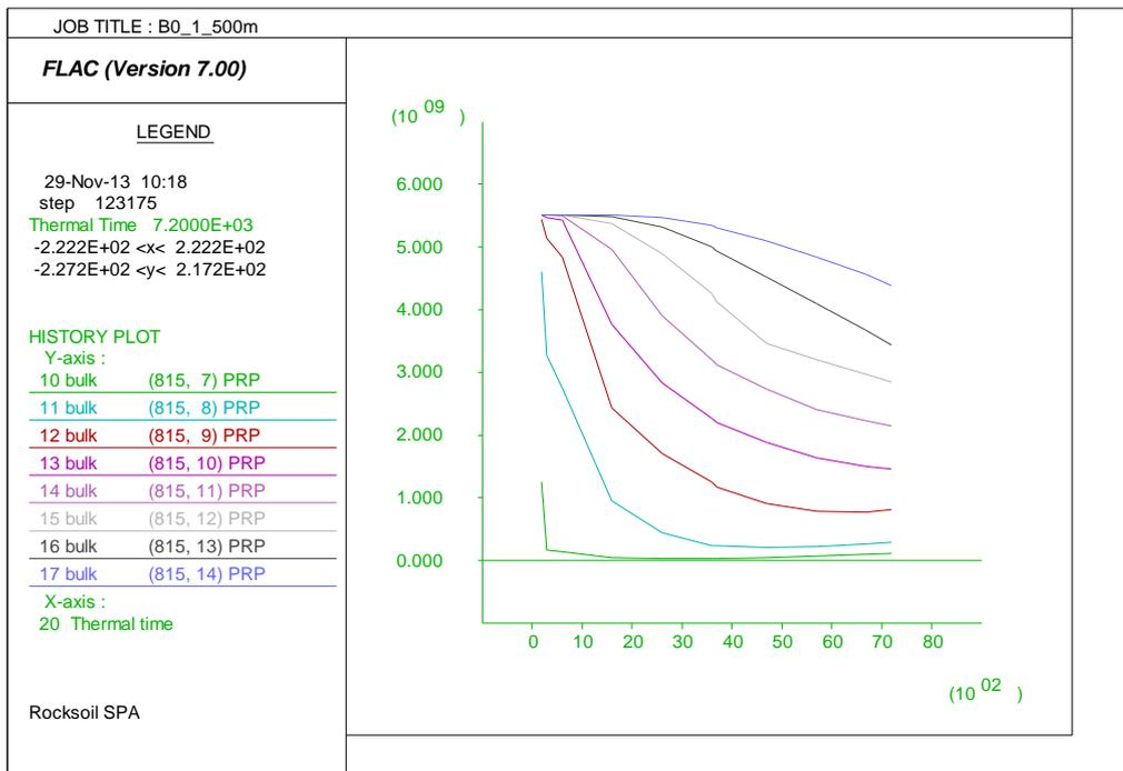
**Figura 25 – Evoluzione del bulk modulus nel rivestimento – Curva EUREKA**
