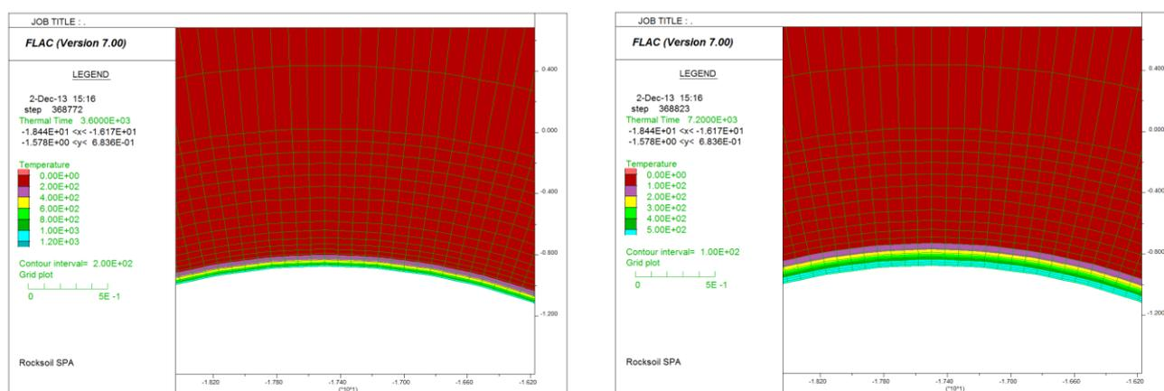
Figura 41 – Distribuzione della temperatura del rivestimento – Curva EUREKA
