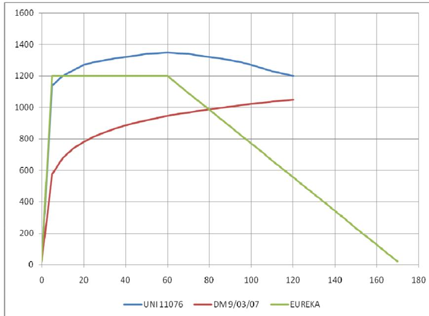
**Figura 1** Comparazione tra le curve d'incendio
