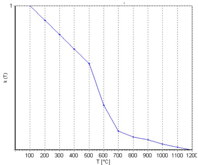
**Figure 7: Fattore di riduzione del valore del modulo elasticoper le barre d'armatura (EN 1992-1-2 p.3.2.3 – tab.3.2.a)**
