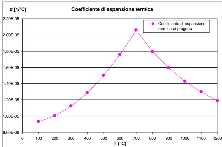
Figura 13 – Coefficiente di espansione termica di progetto
