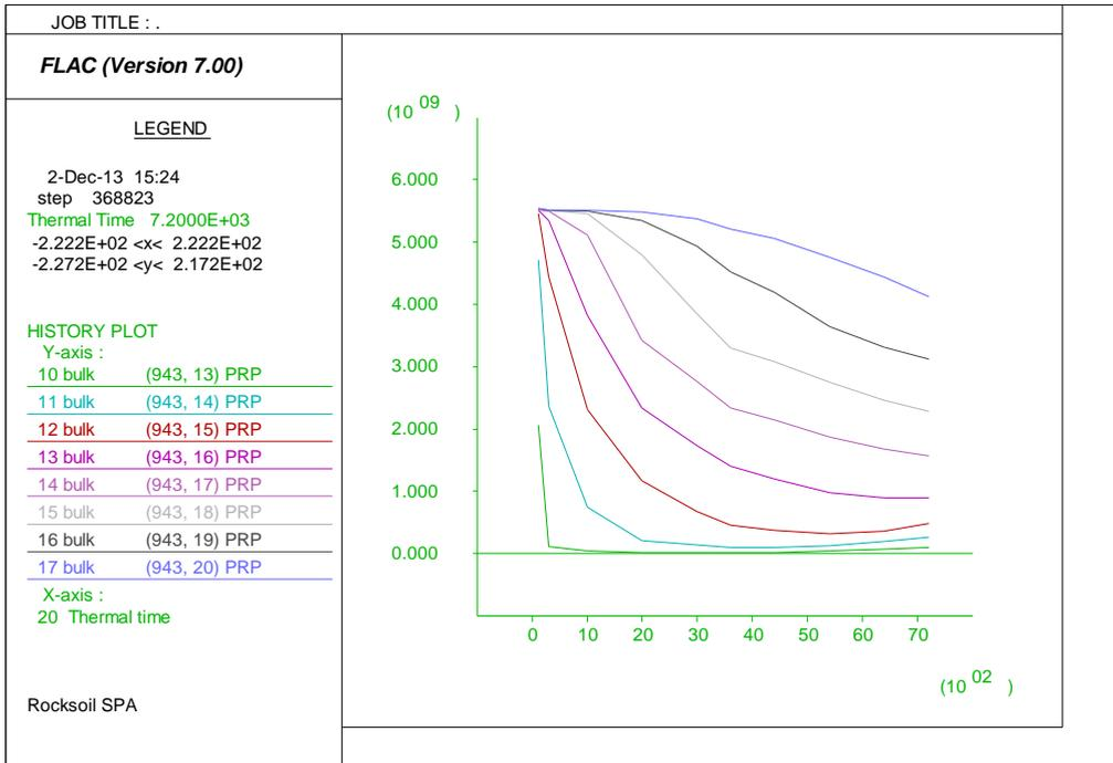
**Figura 50 – Evoluzione del bulk modulus nel rivestimento – Curva EUREKA**
