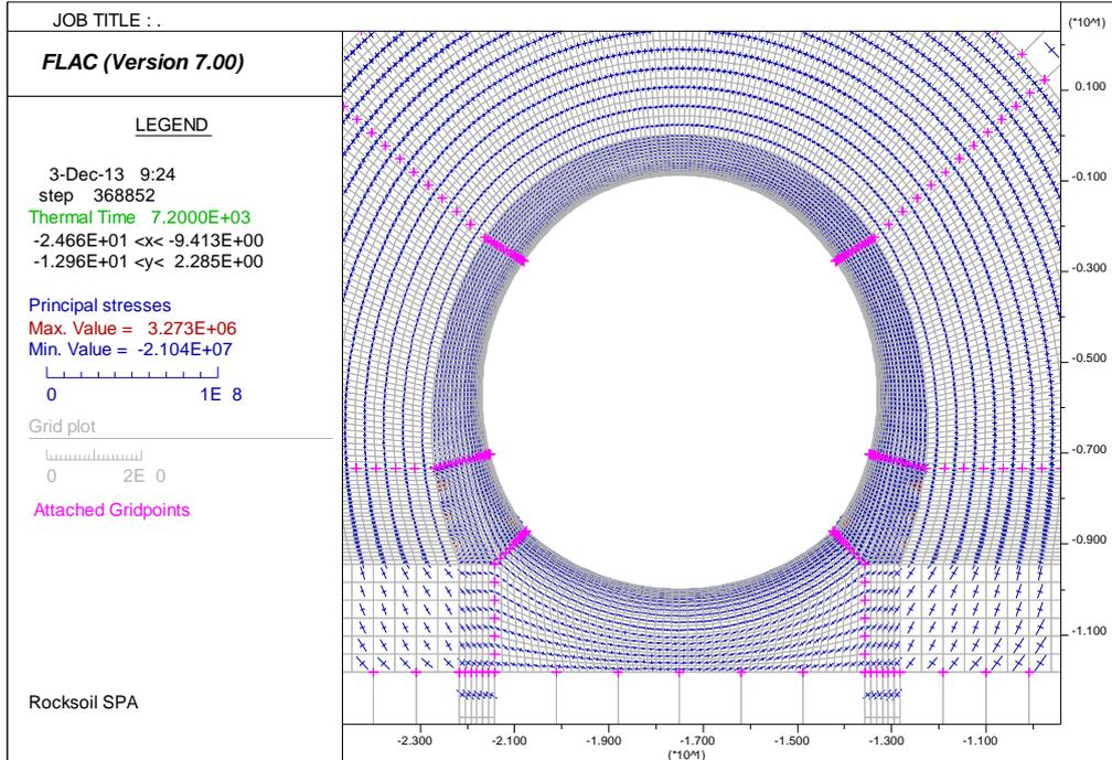
Figura 58 – Stato tensionale – Curva UNI11076 – t = 120 min
