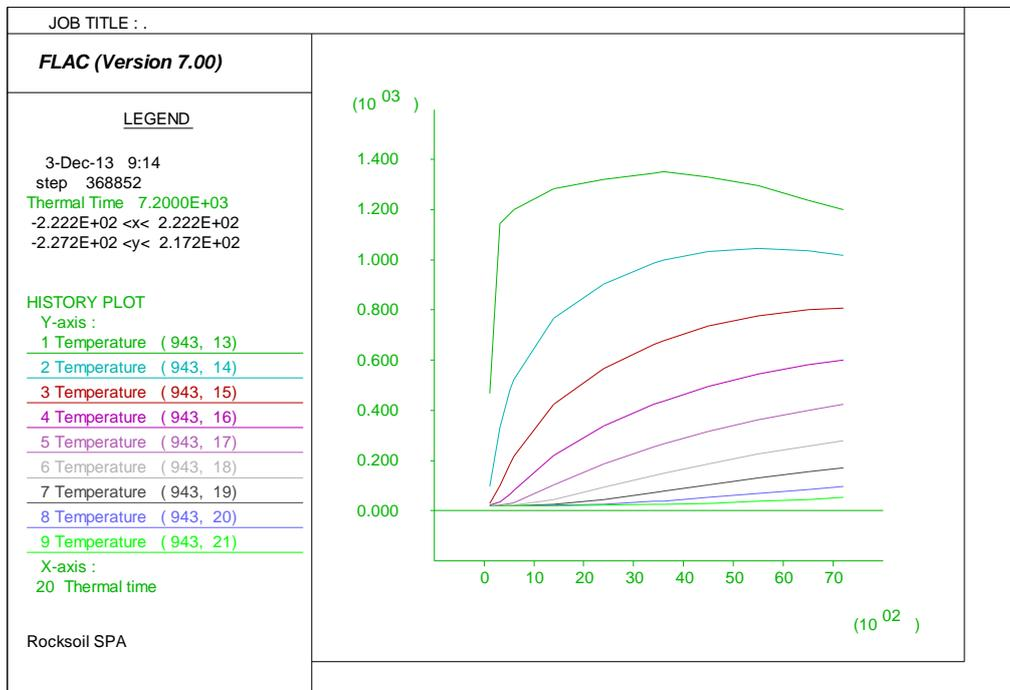
**Figura 45 – Evoluzione della temperatura nel rivestimento – Curva UNI11076**
