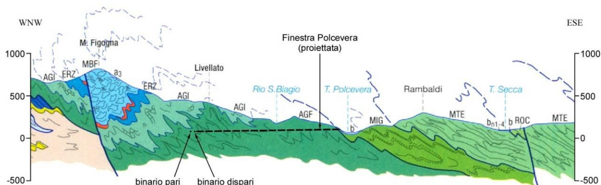
Figura 4-5 – Stralcio del profilo geologico BB’ attraverso la Val Polcevera e la dorsale del M. Figogna; il profilo si colloca in corrispondenza della pk 4+764 (binario pari).
