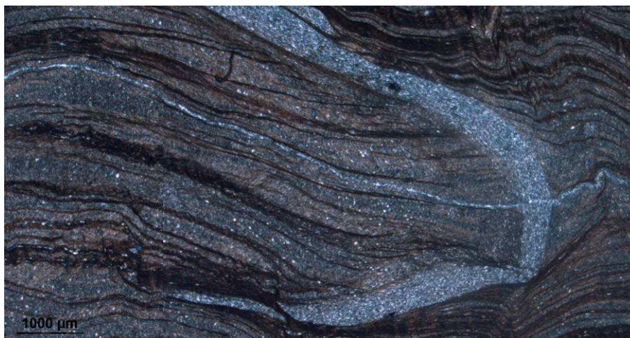
Figura 15 - Foliazione principale negli argilloscisti di Murta, definita da un'alternanza di livelli quarzosi e livelli fillosilicatici, generata da un processo di differenziazione metamorfica. Tale alternanza è tagliata da vene a quarzo successivamente deformate da un piegamento con piano assiale circa concordante con la foliazione principale
