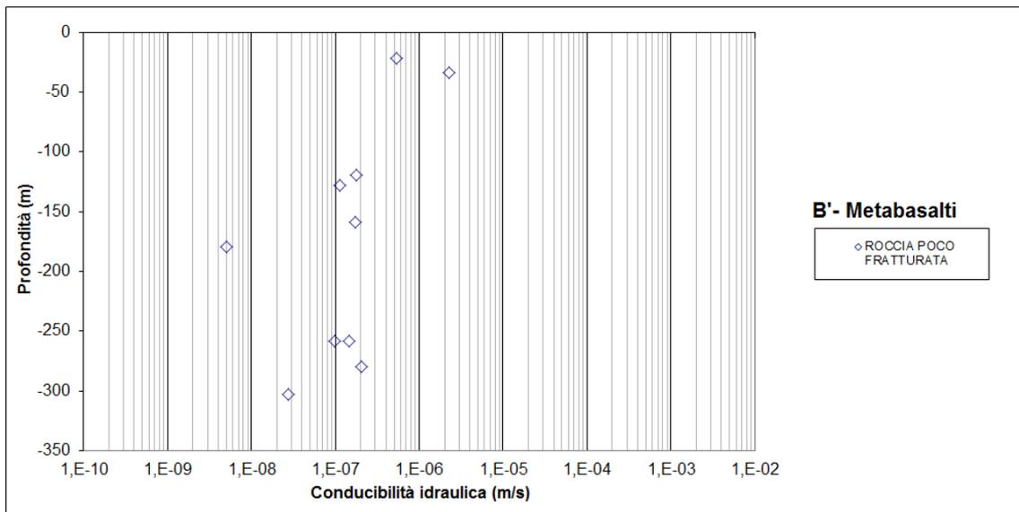
Figura 11. Grafico delle conducibilità idrauliche per i metabasalti.
