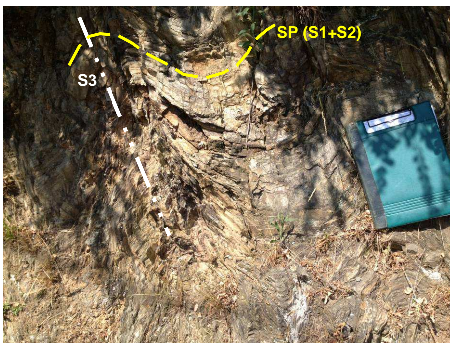
Figura 21 – Argilloscisti pieghettati dalla fase D3 nel settore a W della borgata di Trasta. Si nota un evidente clivaggio di piano assiale, con spaziatura centimetrica, legato alle pieghe D3.
