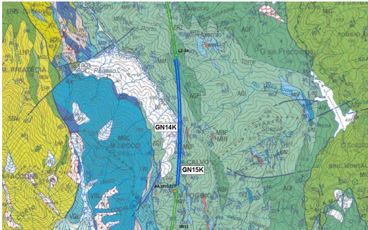
Figura 2 – Stralcio del foglio CARG “Genova”, con individuazione dell’opera in esame e dei sondaggi geognostici realizzati o in fase di realizzazione. Per la legenda geologica (sigle CARG) si veda la Tabella 1.
