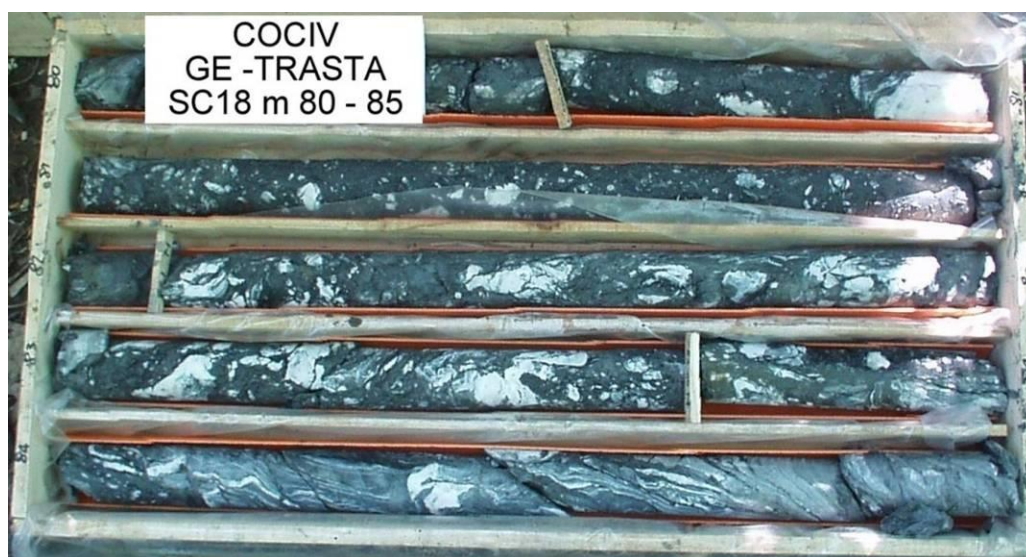
Figura 9 – Sondaggio SC18: esempio di breccie cataclastiche a frammenti chiari (Qz e Ce) in matrice cataclastica grigio-nerastra, localmente argillificata (carote da 80 a 84.1 m). Nel tratto di carota tra 84.1 e 85 m si osserva un ammasso sano, con alcune pieghe D3 centimetrico-decimetriche.
