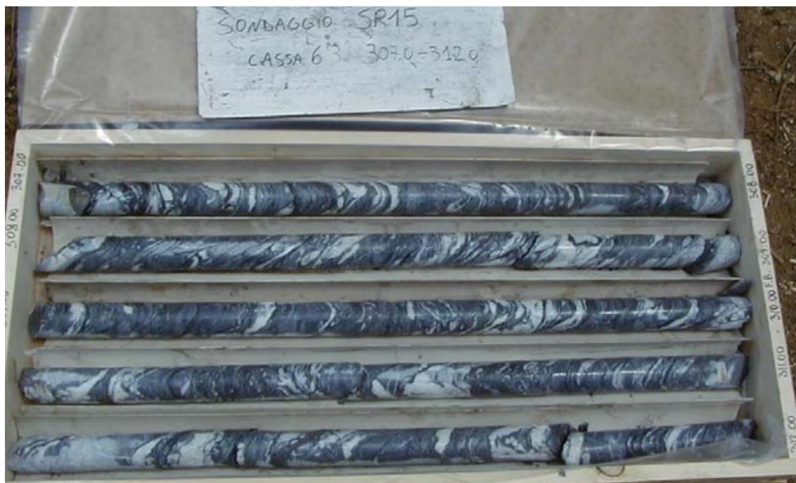
Figura 7. Argille a palombini del Passo della Bocchetta (aP), Sondaggio SR15.
