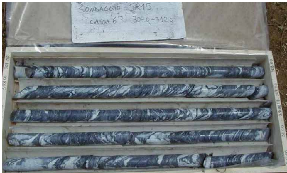
Figura 5 - Argille a palombini del Passo della Bocchetta (aP), Sondaggio SR15.
