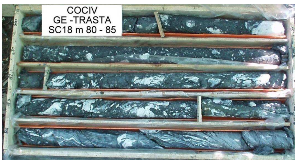
Figura 7 – Sondaggio SC18: esempio di breccie cataclastiche a frammenti chiari (Qz e Cc) in matrice cataclastica grigio-nerastra, localmente argillificata (carote da 80 a 84.1 m). Nel tratto di carota tra 84.1 e 85 m si osserva un ammasso sano, con alcune pieghe D3 centimetrico-decimetriche.
