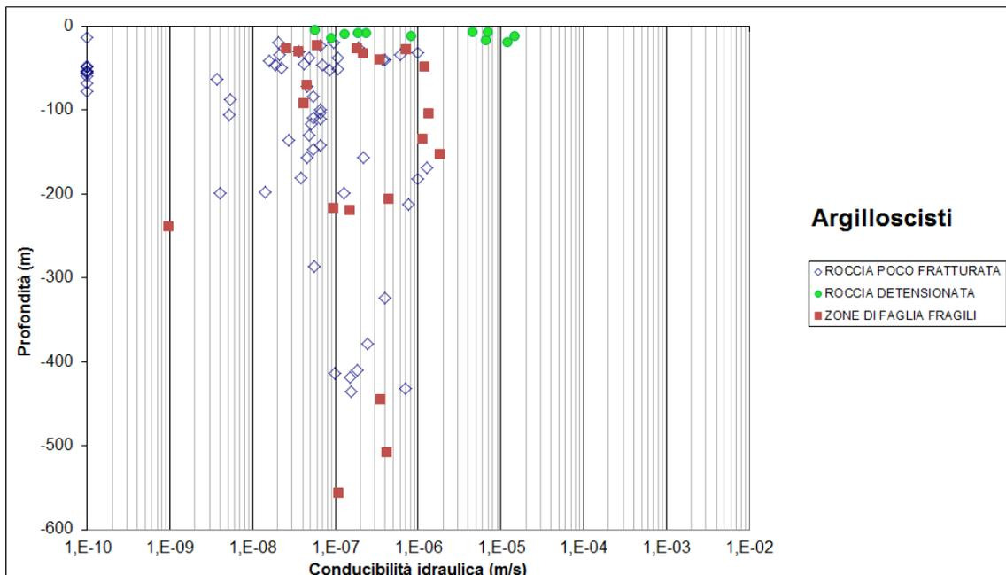
Figura 4. Grafico delle conducibilità idrauliche per gli argiloscisti (Argille a Palombini e argilliti in genere).
