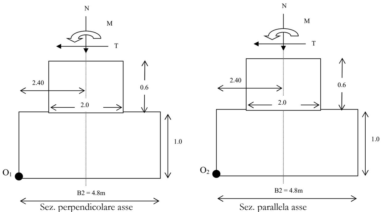
Al centro del dado è previsto il posizionamento del cestello di tirafondi necessario per il collegamento ed ancoraggio dell'antenna.
