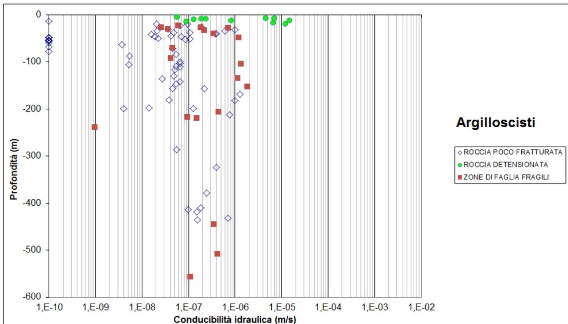
Figura 7. Grafico delle conducibilità idrauliche per gli argiloscisti (Argille a Palombini e argilliti in genere).
