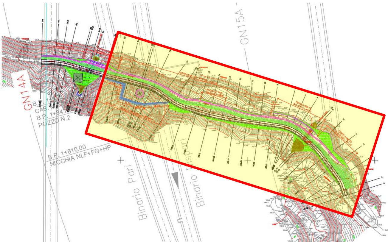
Dal punto di vista altimetrico, le varie livellette costituenti il tracciato sono state raccordate con raccordi circolari; per il raccordo convesso il raggio minimo utilizzato risulta pari a 50m, mentre per quello concavo il raggio minimo è pari a 350 m.
