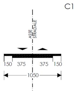
Figura 1 – Composizione della piattaforma stradale secondo NCdS
