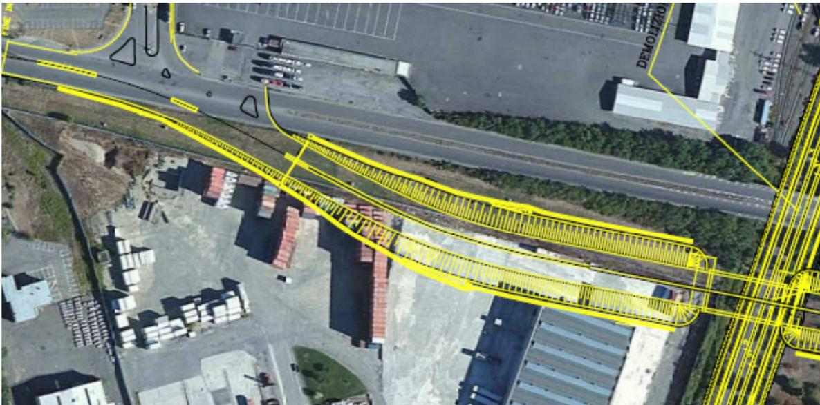
Al fine di eliminare tale interferenza che comporterebbe una variazione importante degli espropri è stato riconfigurato l'andamento plano-altimetrico delle rampe.
