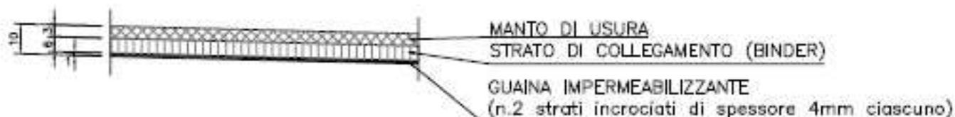
La pavimentazione per la viabilità di collegamento con le strade locali all'intersezione pk. 0+020 ha un'altezza complessiva del pacchetto di 41 cm, composta dall'alto verso il basso come segue:
