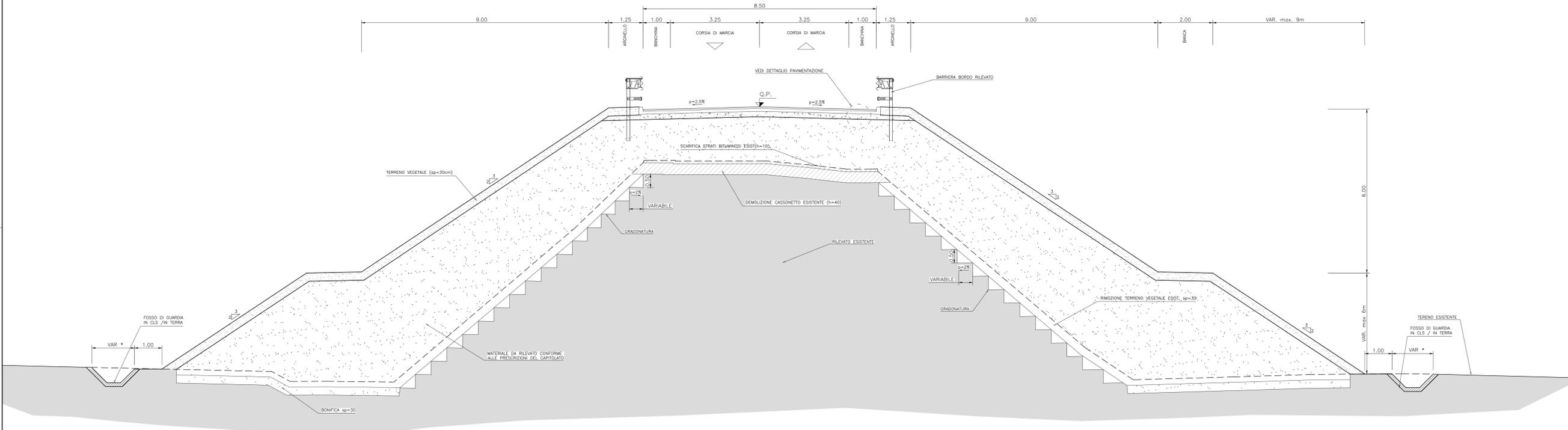
SEZIONE TIPO F2 RILEVATO IN CURVA CON BANCA
