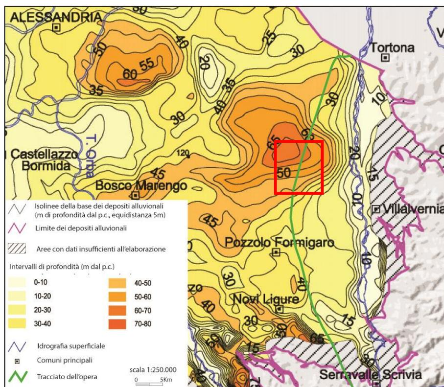
**Figura 3 - Carta schematica della profondità della superficie basale dei depositi alluvionali del settore alessandrino (adattato da Irace et al., 2009). Dalla carta emerge l'estrema irregolarità dell'andamento della superficie basale dei depositi alluvionali lungo il tracciato dell'opera (linea verde), da superficiale a mediamente profondo nei settori di Novi Ligure-Pozzolo Formigaro, con un evidente depocentro nel settore tra Villalvernia e Tortona.**
