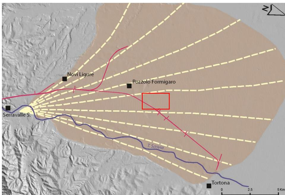
**Figura 8: Rappresentazione schematica dell'estensione areale del conoide del T. Scrivia, dei vari ordini di terrazzi da cui esso è disseccato. Il quadrato rosso indica la posizione dell'opera in progetto.**
