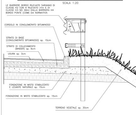
FONDAZIONE IN MISTO GRANULARE STABILIZZATO PER GRANULOMETRIA:
