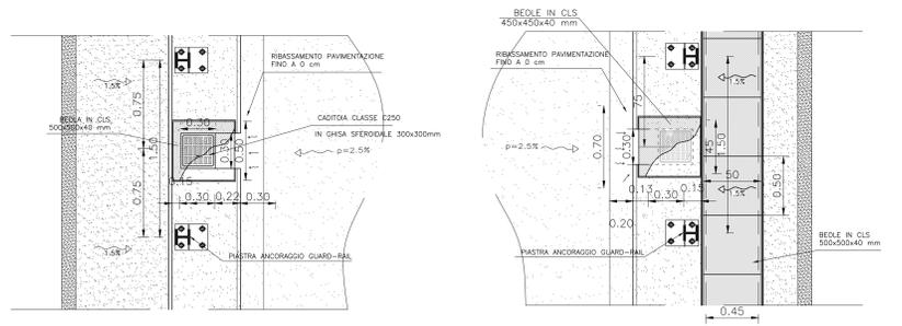
PARTICOLARE POZZETTO CAVIDOTTI - SEZIONE
