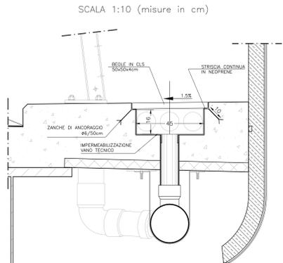
PARTICOLARE POZZETTO CADITOIA - SEZIONE
