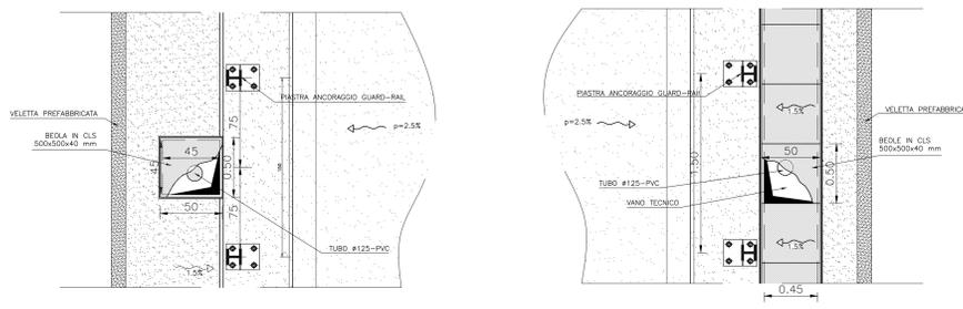
PARTICOLARE POZZETTO CADITOIA - PIANTA
