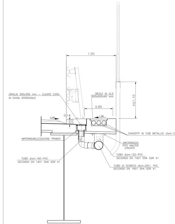
PARTICOLARE SEZIONE SU POZZETTO CAVIDOTTI
