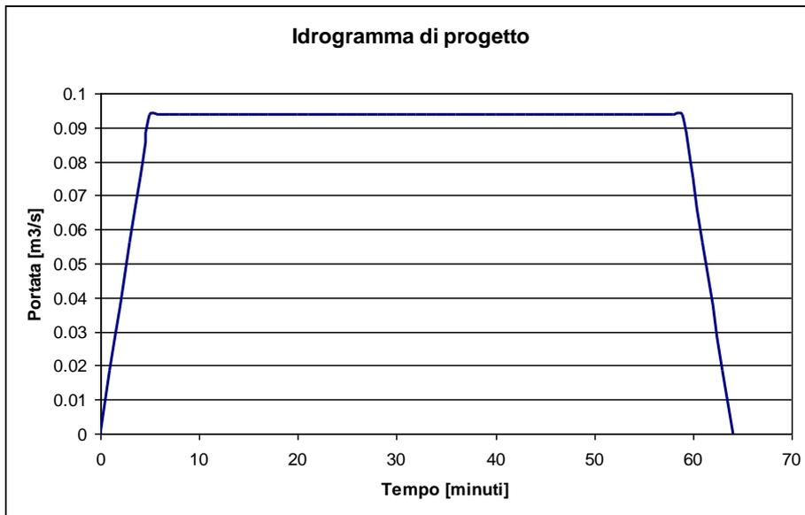
La portata in uscita, che si infila nel terreno attraverso il fondo e le superfici laterali del fosso, è stata valutata moltiplicando la velocità di filtrazione per la superficie (fondo + laterale) bagnata dal liquido. La velocità di filtrazione  $K$  a sua volta è stata valutata assumendo un valore unitario della cadente piezometrica ed un coefficiente di filtrazione pari a  $4 \cdot 10^{-4}$  m/s.
