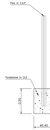
Doppio palo in C.A.P. con saette e isolamento elettrico da predisporre ogni 250 metri
