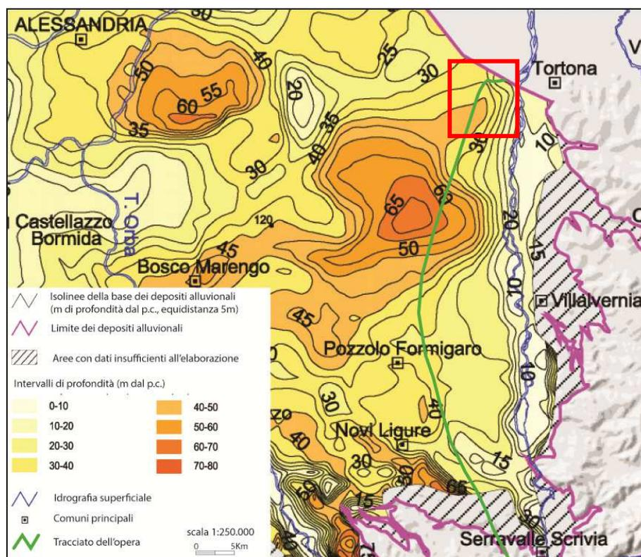
**Figura 3 - Carta schematica della profondità della superficie basale dei depositi alluvionali del settore alessandrino (adattato da Irace et al., 2009). Dalla carta emerge l'estrema irregolarità dell'andamento della superficie basale dei depositi alluvionali lungo il tracciato dell'opera (linea verde), da superficiale a mediamente profondo nei settori di Novi Ligure-Pozzolo Formigaro, con un evidente depocentro nel settore tra Villavernia e Tortona.**
