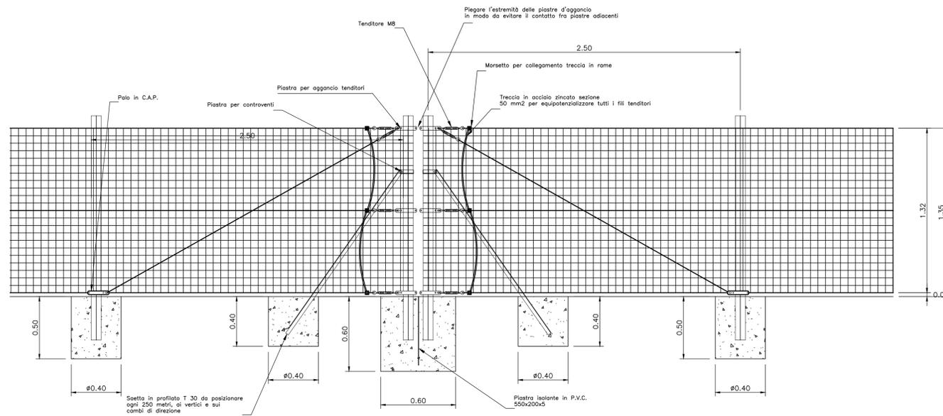
Doppio palo in C.A.P. con saette e isolamento elettrico da predisporre ogni 250 metri
